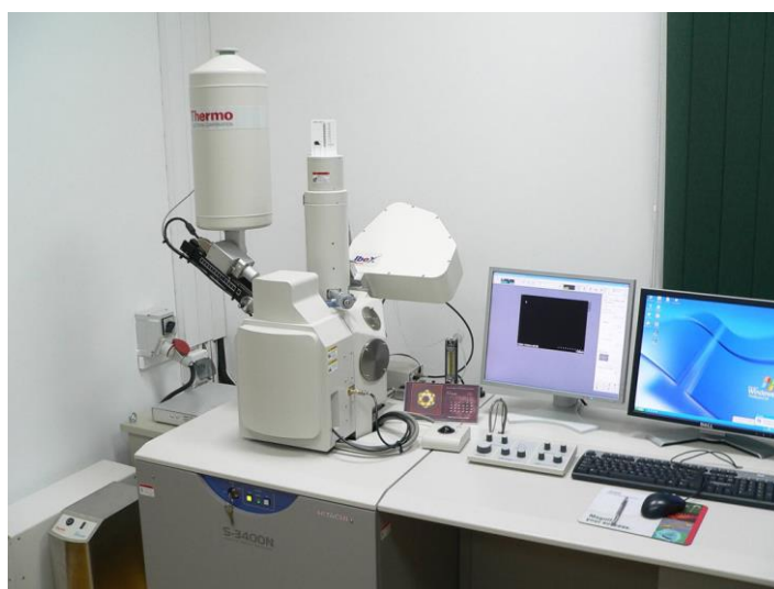
Rys. 9. Elektronowy mikroskop skaningowy HITACHI S-3400N (Katedra Nauki o Materiałach Politechniki Rzeszowskiej im. I. Łukasiewicza) [materiały KNoM]
