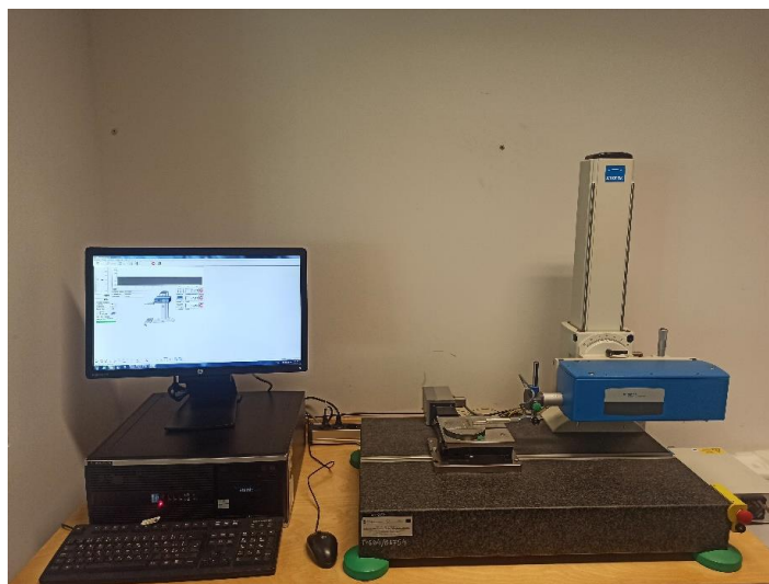
Rys. 7. Zestaw pomiarowy Hommel Etamic Waveline do pomiaru chropowatości 2D i topografii 3D powierzchni obrobionych (Katedra Podstaw Inżynierii Produkcji Politechniki Lubelskiej) [materiały własne z odbytego krajowego stażu badawczego]
