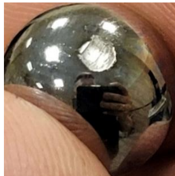
Rysunek 4.6. Zużyta kulka po badaniu w aparacie czterokulowym.
