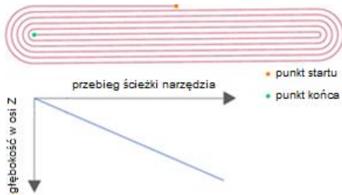
Rys. 4.3. Schemat przebiegu ścieżki narzędzia wg strategii spiralnej.
