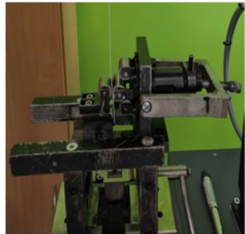
Rys. 3.7. Uniwersalny przyrząd do badania tarcia metodą przeciągania pasa blachy
