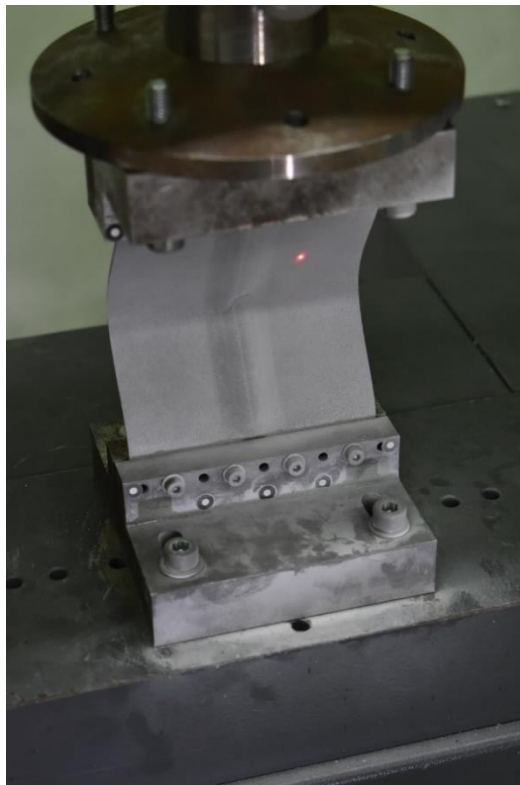
Rys. 5.10. Zamocowanie badanych paneli w uchwytach maszyny wytrzymałościowej.
