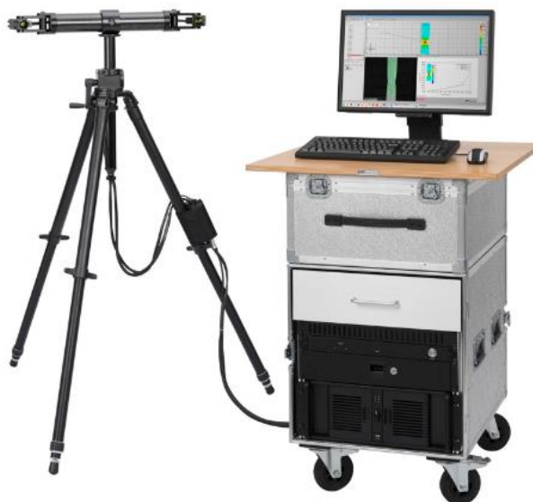
Rys. 3.2. System trójwymiarowej, cyfrowej korelacji obrazu ARAMIS [97].
