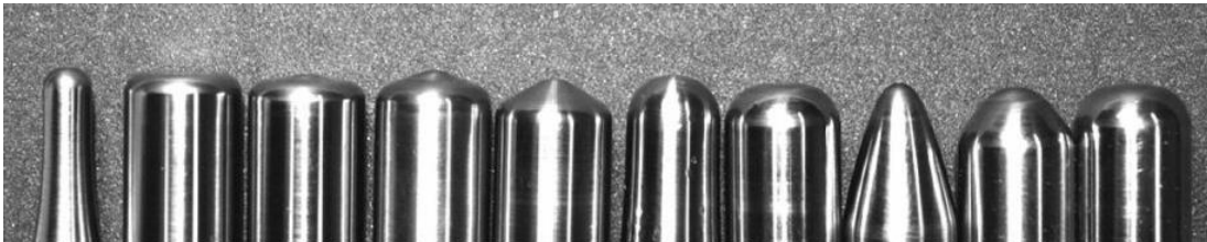
Rys. 1.26. Kształty części roboczych narzędzi do jednopunktowego formowania przyrostowego [36].
