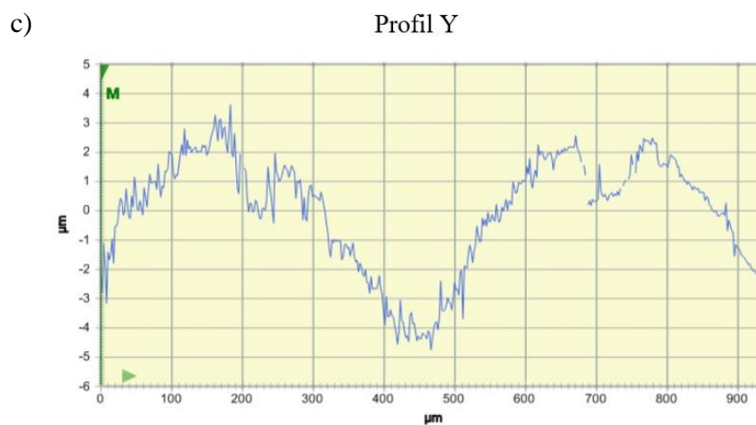
Rys. 4.15. Topografia powierzchni próbki uformowanych przy zastosowaniu a_p = 0,4 \text{ mm} n_n = 18 \text{ obr./min} : a) po uformowaniu przetłoczenia zgodnie ze strategią ciągłego zagłębienia, b) i c) profile kierunkowe topografii powierzchni.
