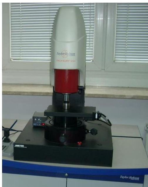
Rys. 3.1. Mikroskop interferencyjny Taylor Hobson Talysurf CCI [95].
