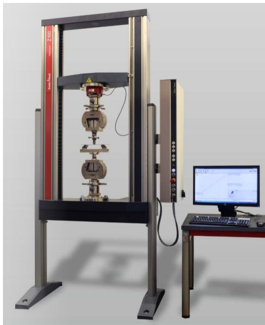
Rys. 3.6. Maszyna wytrzymałościowa Zwick/Roell Z100.
