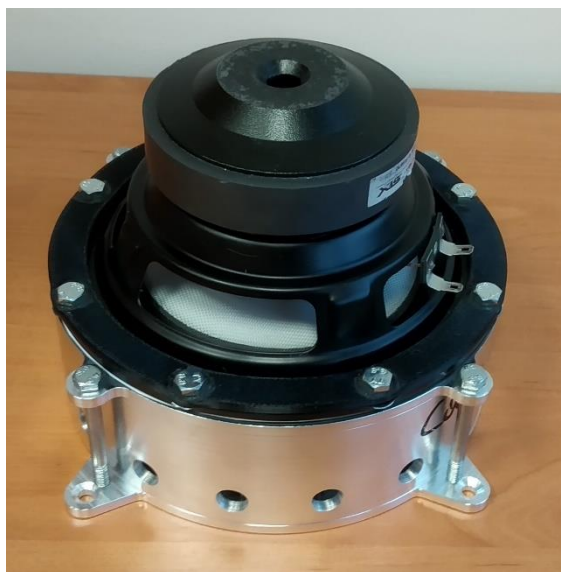
Rys. 10. Modułowy generator strugi syntetycznej ze zintegrowanym radiatorem w komorze
