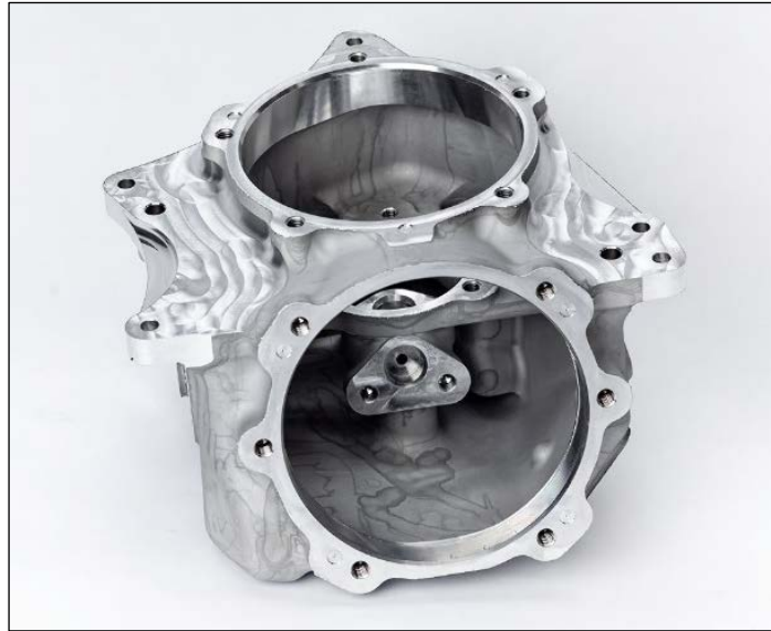
Rysunek 4.5. Korpus przekładni kątowej, element przeniesienia napędu przekładni akcesoriów ADT; Źródło: zdjęcie własne
