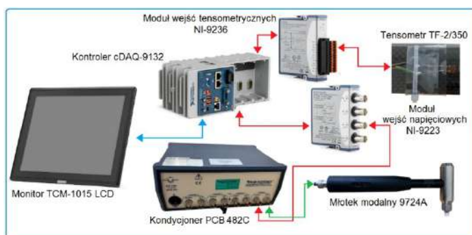
Rys. 3.12. Tor pomiarowy do analizy odkształceń i charakterystyki dynamicznej [217]
