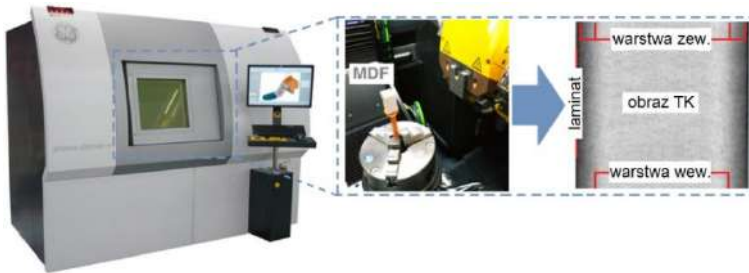
Rys. 3.33. Pomiar gęstości MDF na tomografie rentgenowskim Phoenix v|tome|x m [156]
