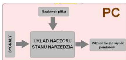
Rys. 8.7. Symulowany układ nadzoru stanu narzędzia
