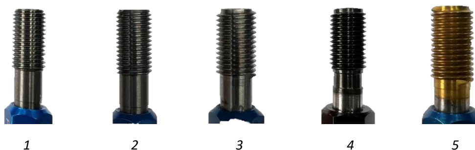
Rys. 4.2 Strony PRZECHODNIE sprawdzianów użytych do testów, 1– wykonany ze stali narzędziowej do pracy na zimno, 2 – z węglika spiekaneego, 3 – ze stali szybko tnącej, 4 – ze stali narzędziowej do pracy na zimno pokryty powłoką DLC, 5 – ze stali szybko tnącej pokryty powłoką TiN
