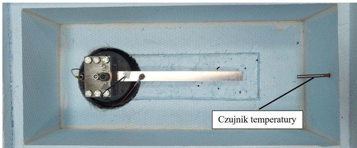
Rys. 3.23. Wnętrze komory chłodzącej z czujnikiem temperatury oraz badaną belką
