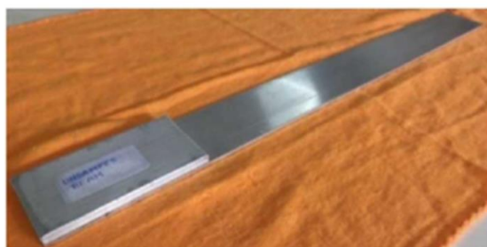
Rys. 2.19. a) Belka Obersta bez tłumienia, b) symetryczna belka warstwowa z tłumieniem (CLD) [78]
