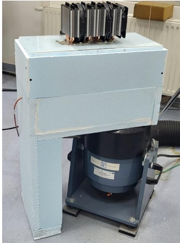
Rys. 3.19. Kompletna komora chłodząca zamocowana do wzbudnika, zbudowana na potrzeby badań skuteczności wibroizolacji w obniżonych temperaturach
