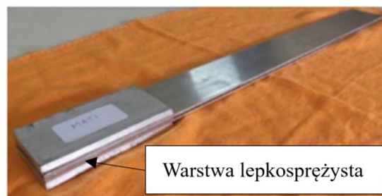
Rys. 2.19. a) Belka Obersta bez tłumienia, b) symetryczna belka warstwowa z tłumieniem (CLD) [78]
