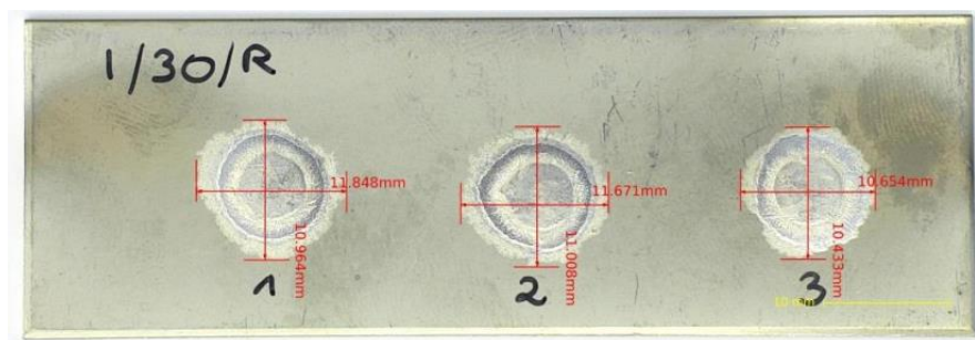
Rys. 137. Wyniki próby rozplywności lutu Palnico 36M na podłożu nadstopu Inconel 718 po procesie lutowania w czasie 30 min
