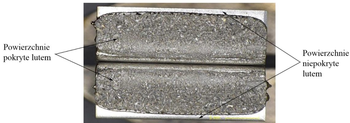
Rys. 42. Przykładowe powierzchnie próbki po próbie odrywania z oznaczonymi obszarami pokrytymi i niepokrytymi lutem
