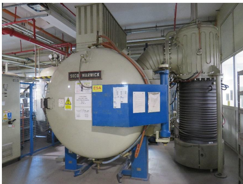
Rys. 40. Piec próżniowy Seco/Warwick VP-4050/72HV do procesu lutowania
