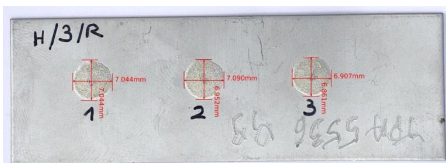
Rys. 113. Wyniki próby rozpuszczalności lutu Vitta-Braze 1996 na podłożu nadstopu Hastelloy X po procesie lutowania w czasie 3 min
