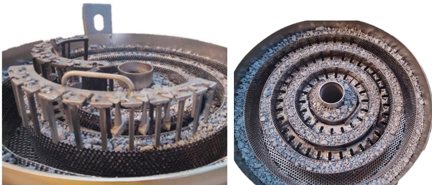
Rys. 20. Mufla do procesów aluminiowania Łopatek Turbiny.
