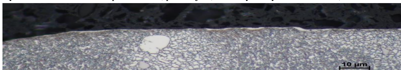
Rys. 172. Mikrostruktura łopatki nr N68, przekrój III, trawiony odczynnikiem AG-21, biała warstwa.
