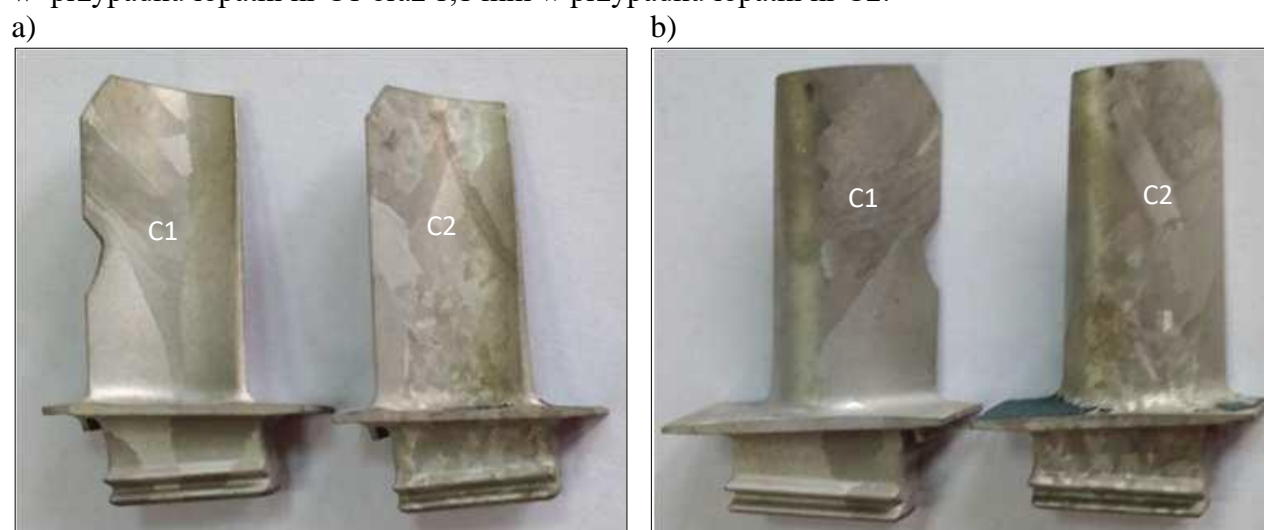
Rys. 63. Makrostruktura Łopatki turbiny napędowej ze stopu ŻS6U-WI, odlew C.: a) powierzchnia od strony koryta, b) powierzchnia od strony grzbietu, stan trawiony odczynnikiem ( \text{FeCl}_3+\text{HNO}_3+\text{HCl}+\text{H}_2\text{O} ), pow. \sim 1,2x .
