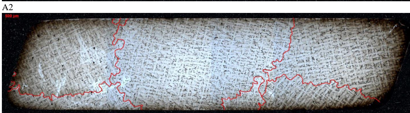
Rys. 61. Mikrostruktura z obszaru zamka łożatki A1 oraz A2, zgląd trawiony, odczynnik Kalling, LM; czerwoną linią zaznaczono granice ziarn – oddzielające obszary o różnej orientacji krystalograficznej dendrytów.
