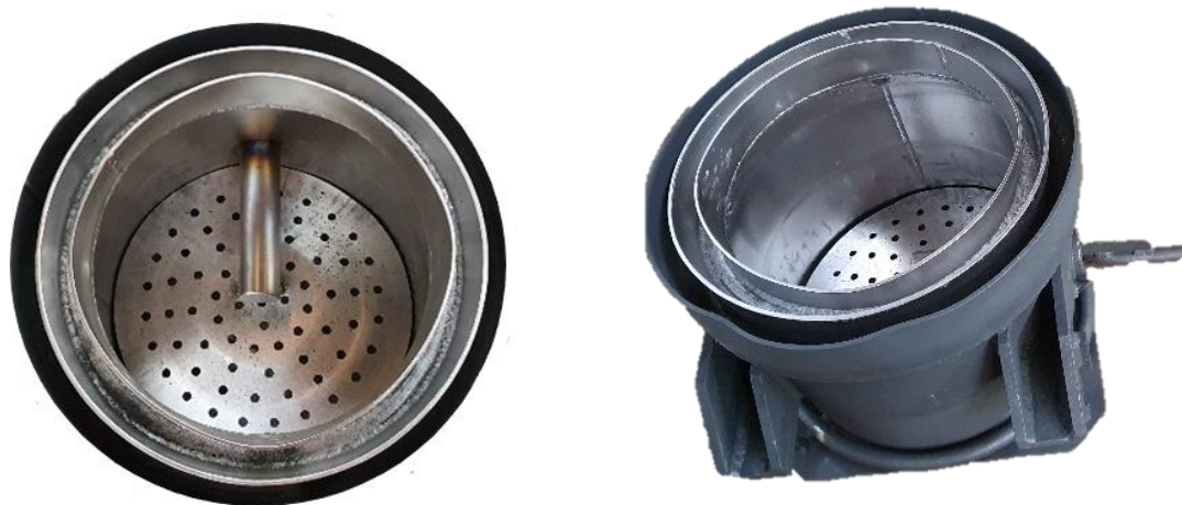
Rys. 12. Oprzyrządowanie do obróbki cieplnej nadstopów w atmosferze ochronnej (argon) – mufla.
