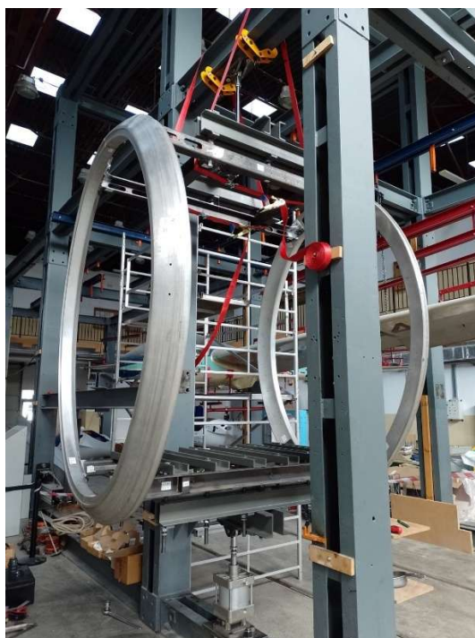
Rys. 22. Widok ukośny na zmontowaną gondolę do kolei linowych, przygotowaną do przeprowadzenia badań zmęczeniowych, zgodnie z normą PN-EN 13796-3.
