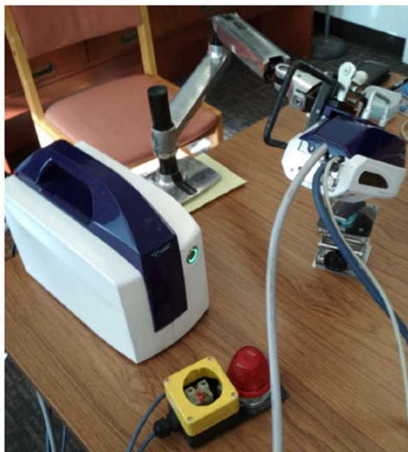
Rys. 14. Pomiar naprężeń szczątkowych z wykorzystaniem systemu Pulstec.
