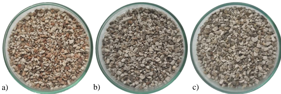
Rysunek 2. Trawertyn prażony w temperaturze a) 500°C b) 650°C c) 700°C
