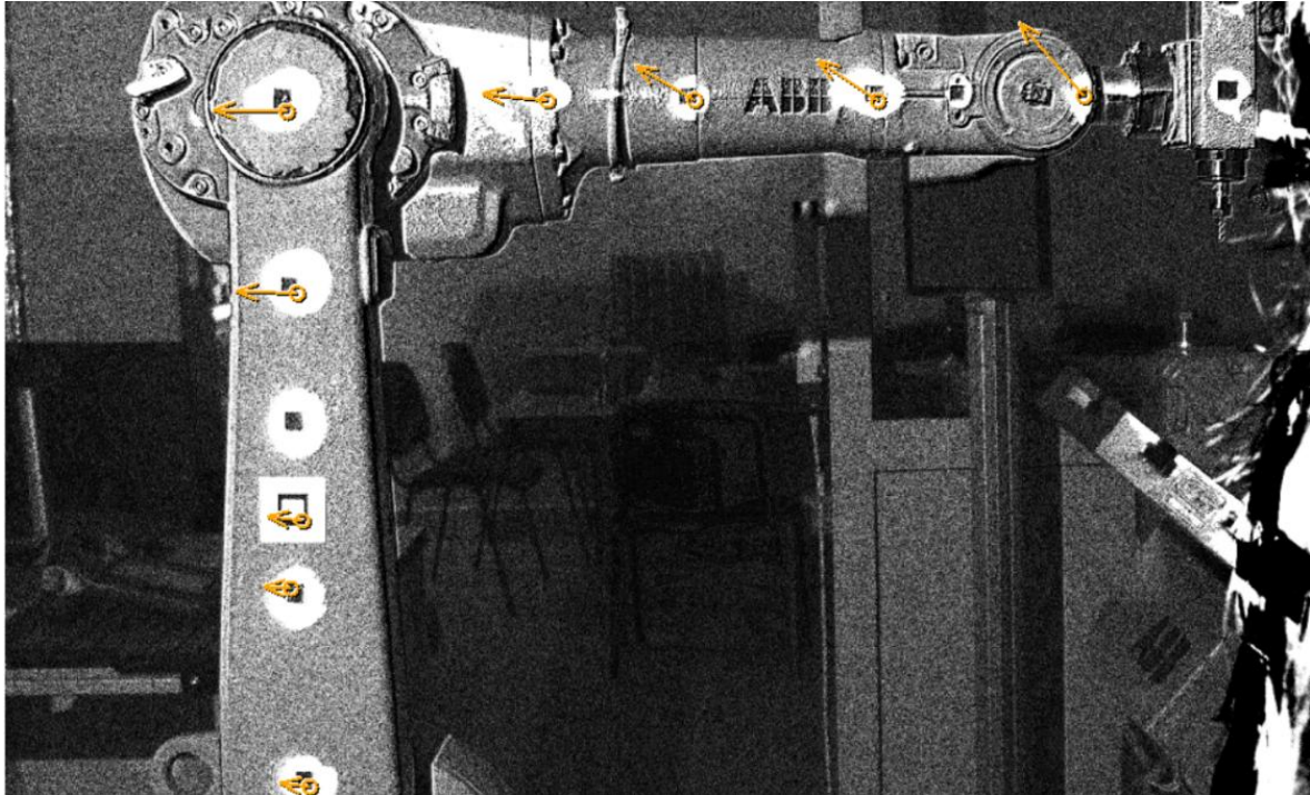
Rys. 7.27. Całkowite drgania ramienia robota przy ustawieniu kątowym \beta_2 = \beta_3 = 0^\circ
