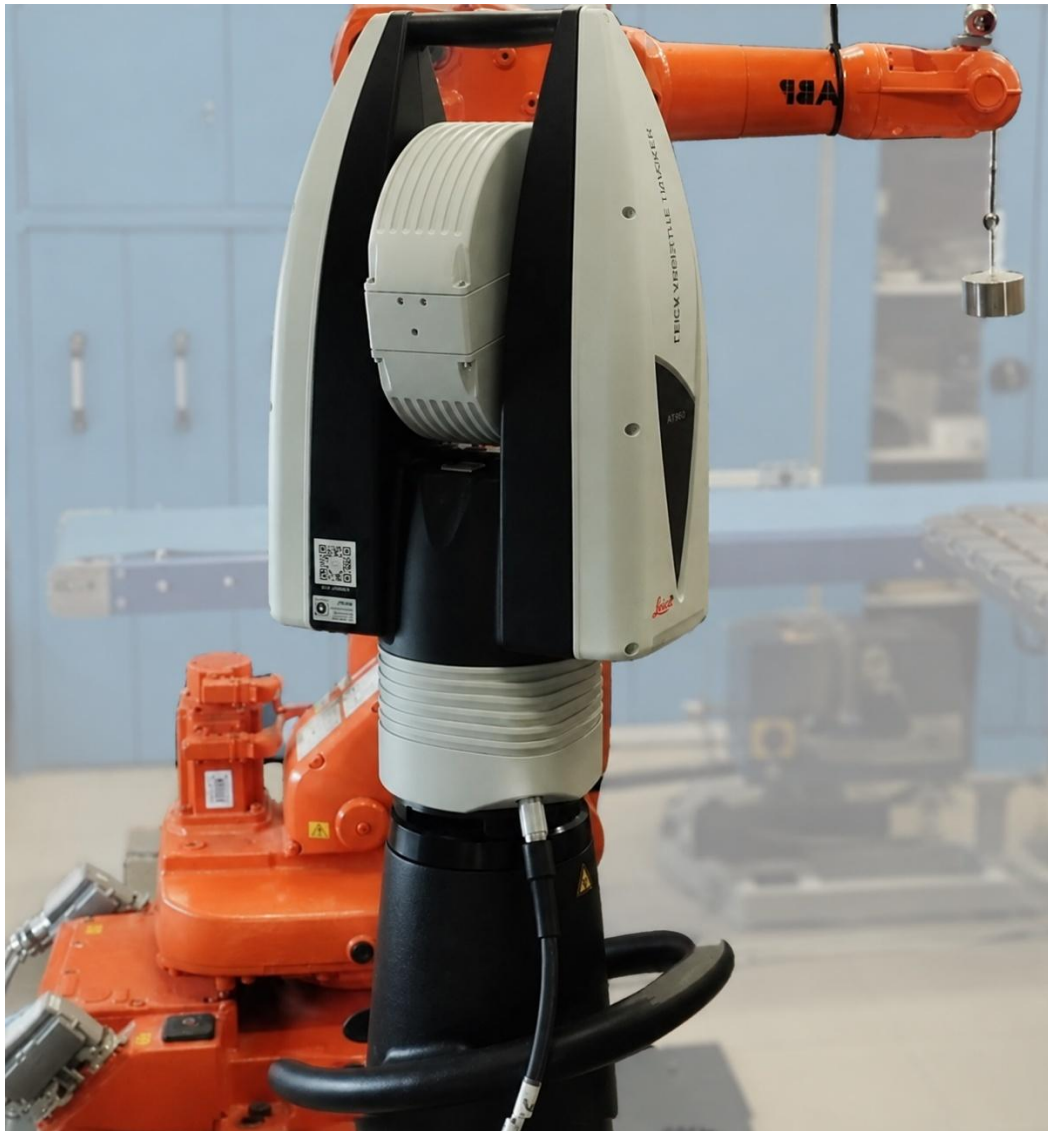
Rys. 4.3. Pomiar przemieszczeń ogniów robota pod obciążeniami z zastosowaniem absolutnego trackera laserowego Leica AT 960
