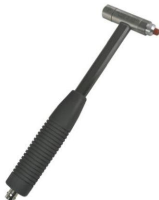
Rys. 7.3. Młotek modalny PCB [139]
