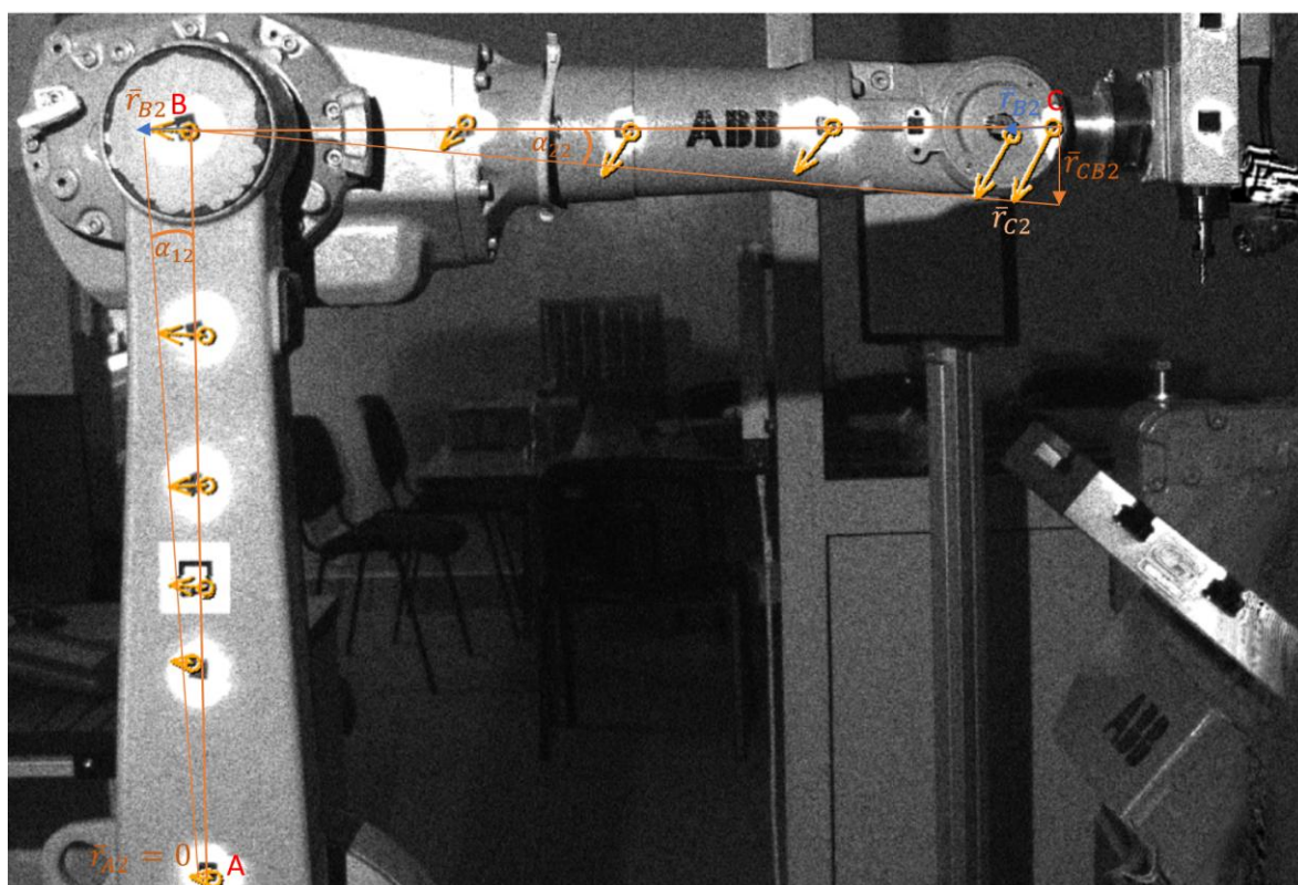
Rys. 8.15. Drgania ramienia robota dla drugiego modu drgań
