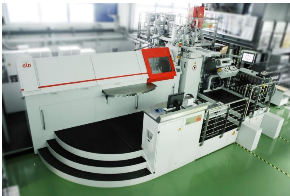
Rys. 2.7. Urządzenie SMART COATER firmy ALD Vacuum Technologies GmbH w Uczelnianym Laboratorium Badań Materiałów dla Przemysłu Lotniczego Politechniki Rzeszowskiej [110]
