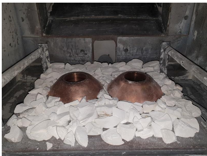
Rys. 2.10. Wnętrze komory roboczej urządzenia SMART Coater, widoczne tygle miedziane i układ rur dozujących gazy procesowe
