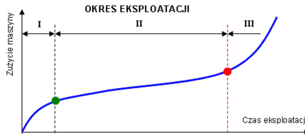
Rysunek 2.4. Etapy eksploatacji maszyn: I – docieranie, II – zużycie normalne, III – zużycie przyspieszone [14]
