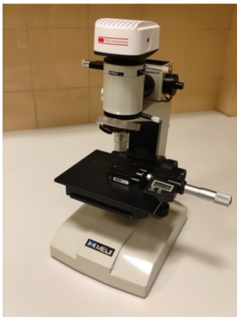
Rysunek 4.5. Mikroskop optyczny Meiji Techno ML7000 (fot. własna)
