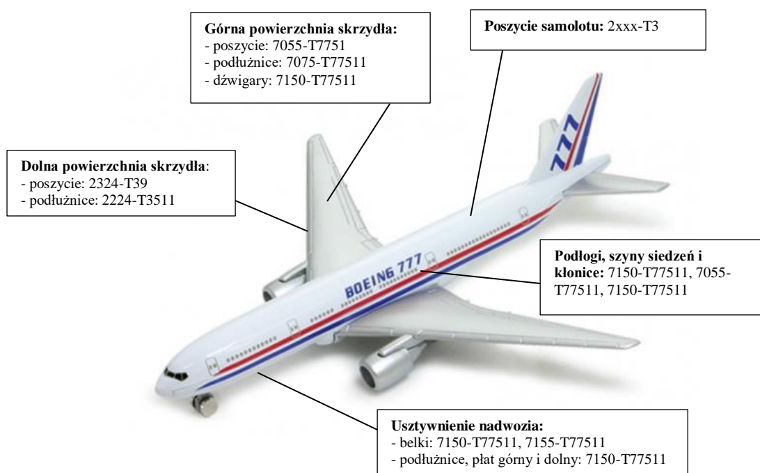
Rys. 2.5. Zastosowanie stopów aluminium w cywilnym samolocie Boeing 777 [98]
