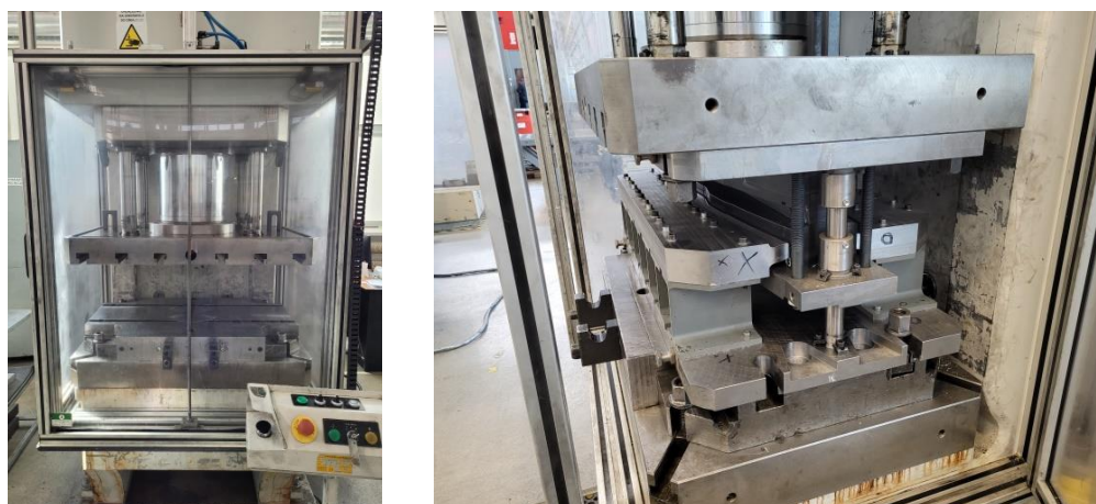
Rys. 10.13. Prasa hydrauliczna użyta w drugiej operacji kształtowania (z lewej) wraz z założonym tłocznikiem (z prawej)
