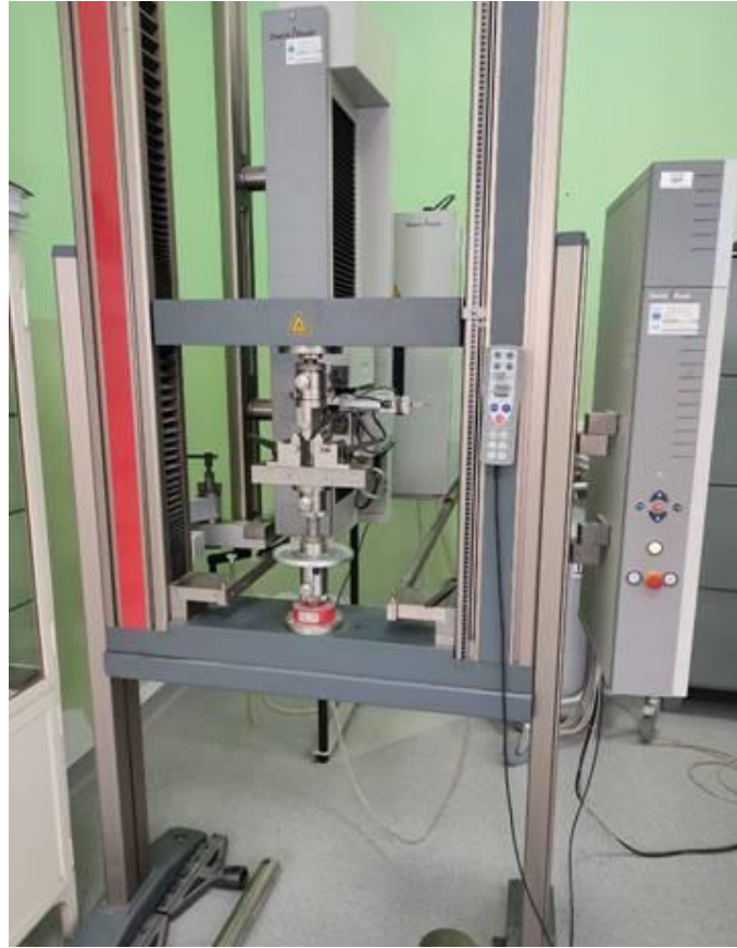
Rys. 8.1. Stanowisko do gięcia
