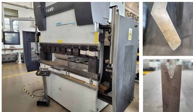
Rys. 10.12. Prasa krawędziowa użyta w procesie formowania pierwszej operacji wraz z oprzyrządowaniem
