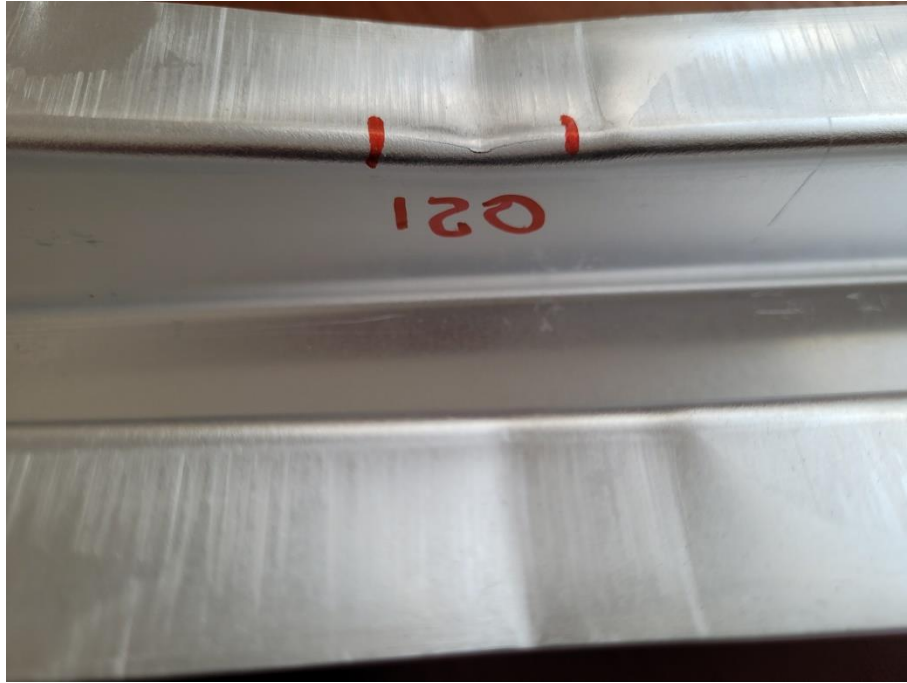
Rys. 10.16. Wada wytłoczki kształtowanej 120 min po przesycaniu w świetle dziennym
