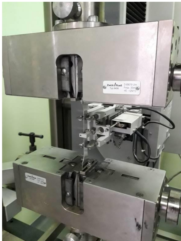
Rys. 6.3. Przykładowa próbka w trakcie próby jednoosiowego rozciągania
