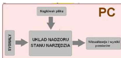
Rys. 71. Symulowany układ nadzoru stanu narzędzia
