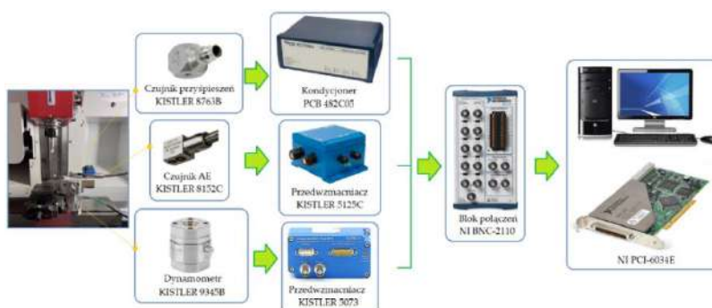
Rys. 17. Konfiguracja eksperymentalna i schemat systemu akwizycji danych
