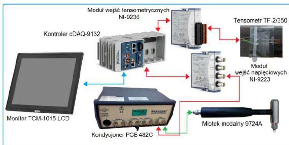
Rys. 2. Tor pomiarowy do analizy odkształceń i charakterystyki dynamicznej
