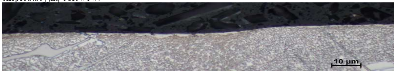
Rys. 162. Mikrostruktura łopatki nr N68, przekrój I, trawiony odczynnikiem AG-21, biała warstwa.
