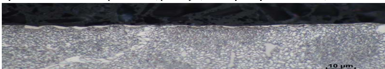
Rys. 164. Mikrostruktura łopatki nr N68, przekrój III, trawiony odczynnikiem AG-21, biała warstwa.
