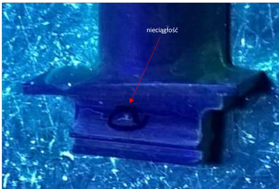
Rys. 31. Wyniki kontroli FPI ze wskazaniem nieciągłości na zamku Łopatki Turbiny Sprężarki.
