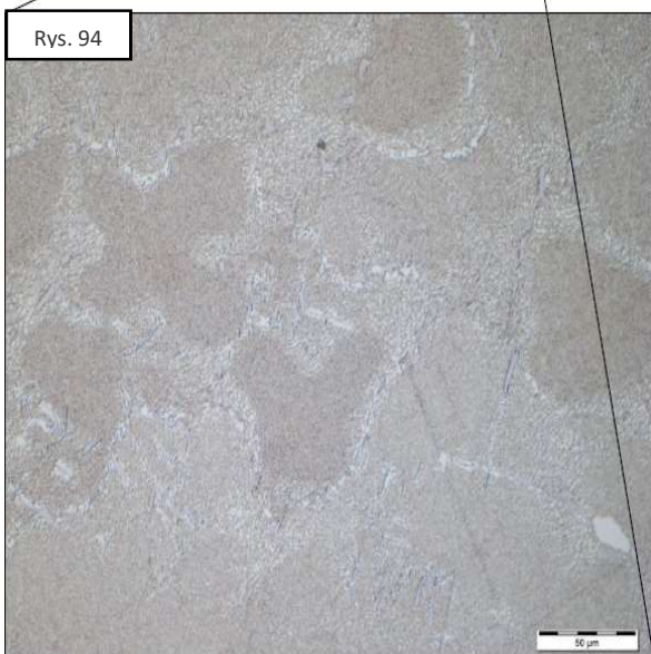
Rys. 92÷94. Mikrostruktura łożatki z odlewu 1J po przesycaniu z temperatury 1210°C.
