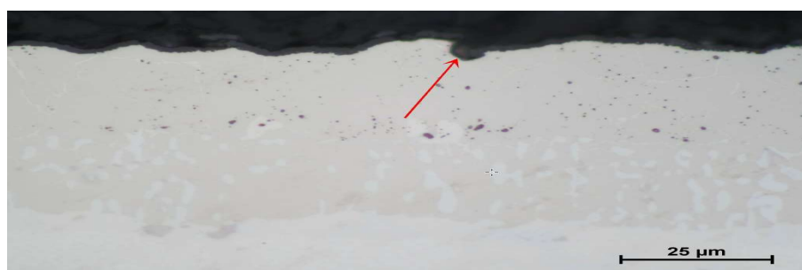
Rys. 141. Powierzchnia warstwy aluminiowanej – czerwoną strzałką wskazano wżer tlenkowy.
