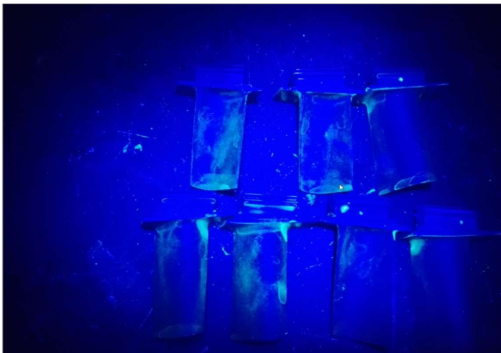
Rys. 147. Wyniki kontroli FPI ze wskazaniem nieciągłości na Łopatkach Turbiny Sprężarki.
