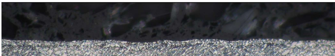
Rys. 169. Mikrostruktura łopatki nr N70, przekrój II, trawiony odczynnikiem AG-21, słabe odkształcenie.
