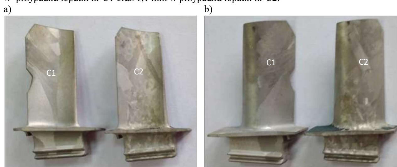
Rys. 63. Makrostruktura Łopatki turbiny napędowej ze stopu ŻS6U-WI, odlew C.: a) powierzchnia od strony koryta, b) powierzchnia od strony grzbietu, stan trawiony odczynnikami ( \text{FeCl}_3+\text{HNO}_3+\text{HCl}+\text{H}_2\text{O} ), pow. \sim 1,2x .
