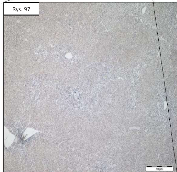
Rys. 95÷97. Mikrostruktura łożatki z odlewu 2J w stanie lanym.
