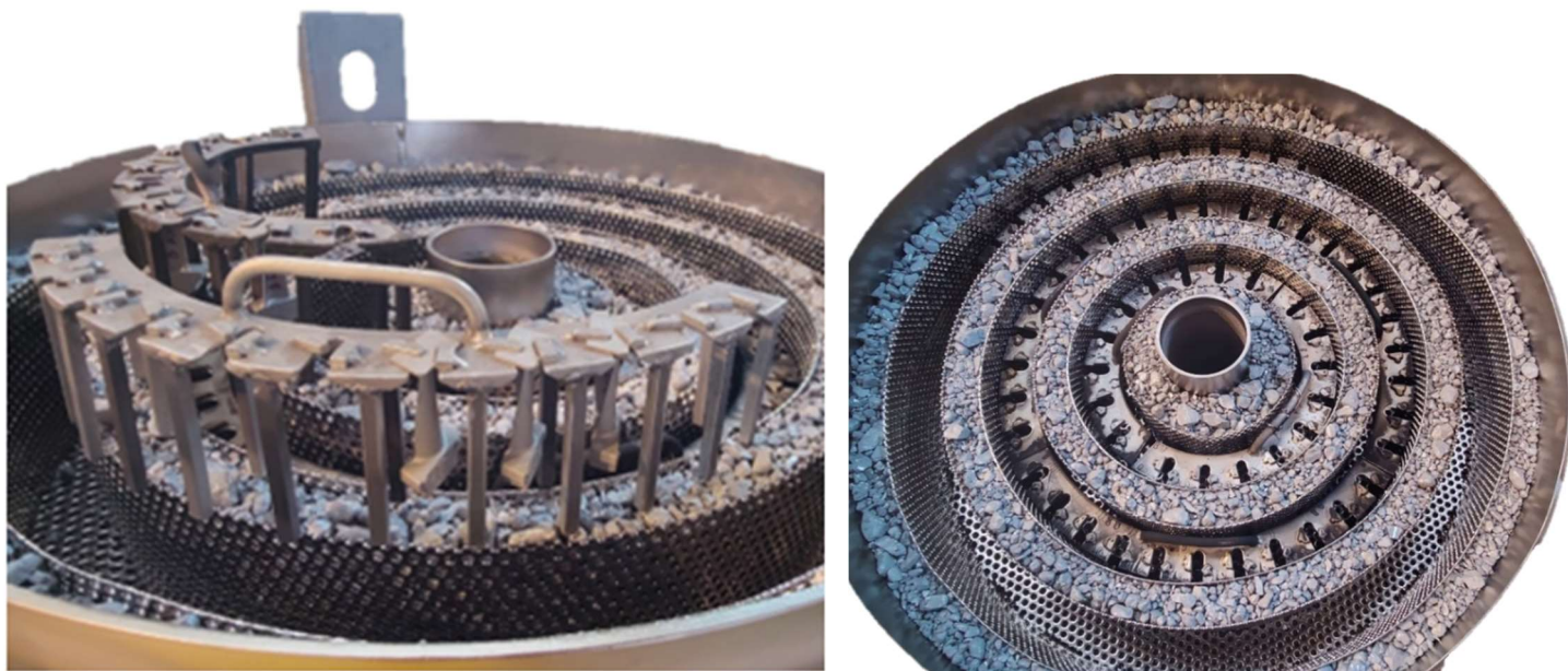
Rys. 20. Mufla do procesów aluminiowania Łopatek Turbiny.
