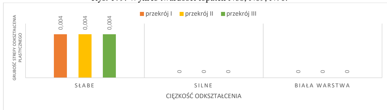
Rys. 171. Wykres wpływu procesów powierzchniowej obróbki wykańczającej na odkształcenie powierzchni łopatki nr N70.
