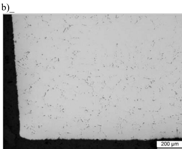
Rys. 42. Mikrostruktura stopu ŻS6U-WI (odlew 3) w obszarze prawego dolnego rogu łopatki (PD), stan nietrawiony, LM - a) pow. 50x, b) pow. 100x.
