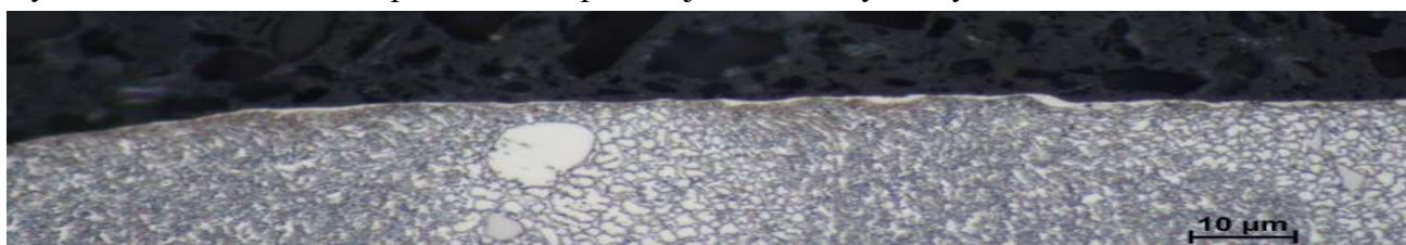
Rys. 165. Mikrostruktura łopatki nr N69, przekrój I, trawiony odczynnikiem AG-21, biała warstwa.
