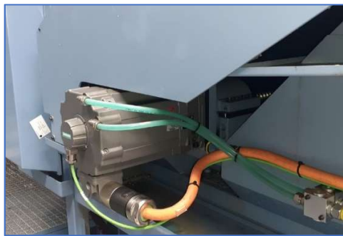
Rys. 2.1. Układy stabilizacji temperatury centrum obróbczego: a) schemat ideowy układu stabilizacji temperatury (dokumentacja DTR obrabiarki), b) silnik osi liniowej z widocznym doprowadzeniem cieczy stabilizującej temperaturę, c) układ nawiewowy stabilizujący temperaturę przestrzeni ażurowych podstawy obrabiarki
