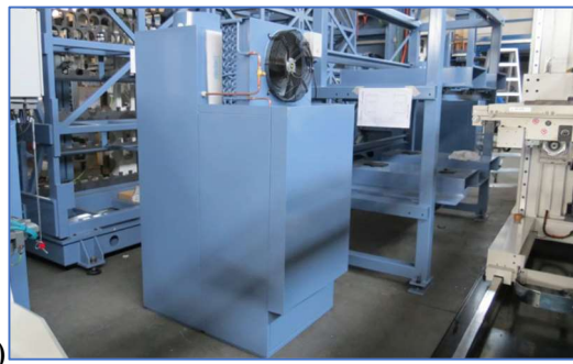
Rys. 2.1. Układy stabilizacji temperatury centrum obróbczego: a) schemat ideowy układu stabilizacji temperatury (dokumentacja DTR obrabiarki), b) silnik osi liniowej z widocznym doprowadzeniem cieczy stabilizującej temperaturę, c) układ nawiewowy stabilizujący temperaturę przestrzeni ażurowych podstawy obrabiarki
