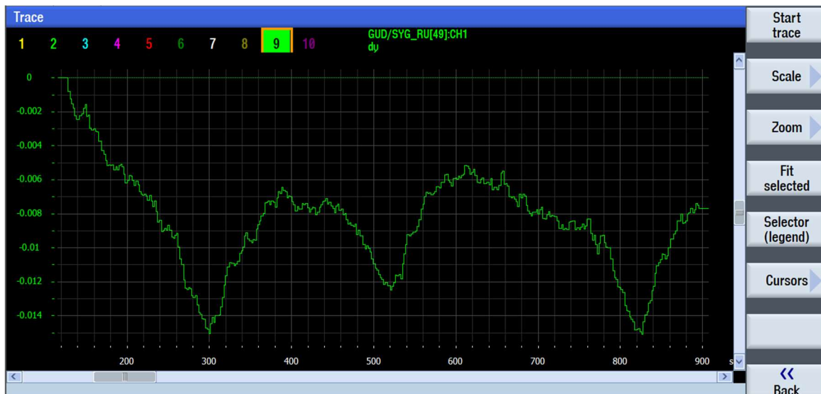
Rys. 8.6. Widok okna graficznej wizualizacji danych (Trace Sinumerik), przewidzianych przemieszczeń TCP w osi Y
