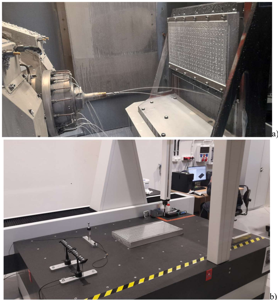
Rys. 8.8. Widok przedmiotu testowego: a) w przestrzeni roboczej obrabiarki b) podczas weryfikacji wymiarów na maszynie współrzędnościowej Altera-M20.12.10
