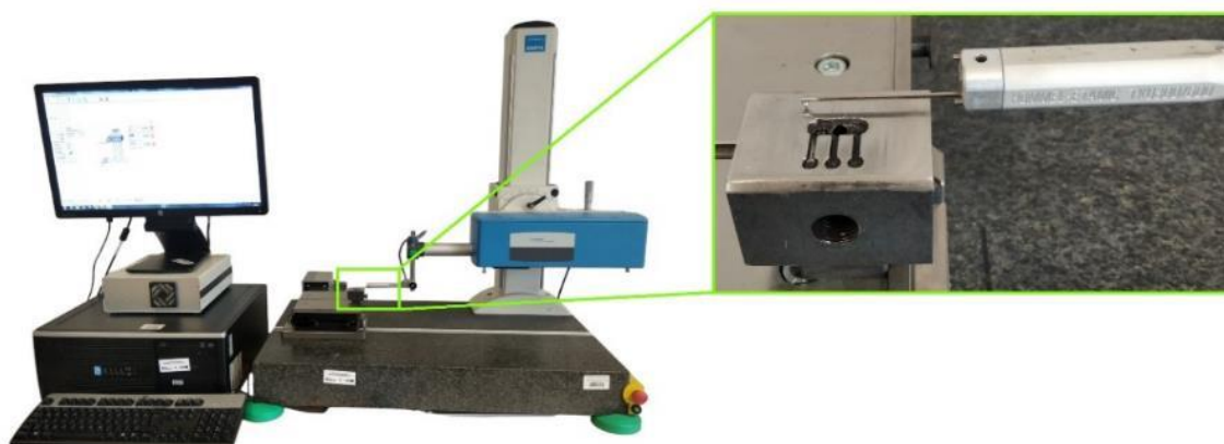
Rys. 4.7. Pomiar topografii powierzchni przeciwpróbek
