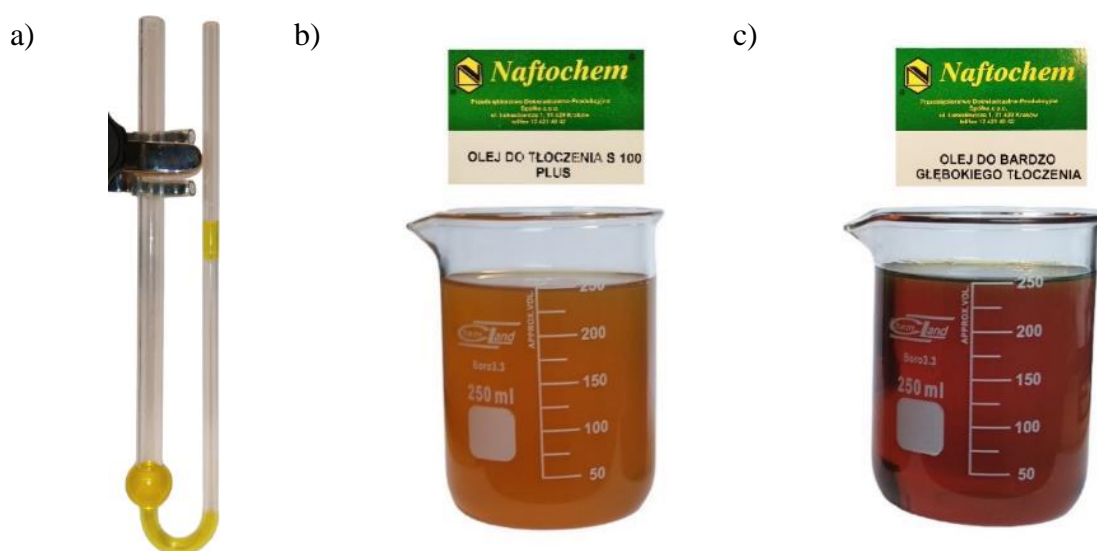
Rys. 3.15. a) wiskozymetr Ostwalda, b) olej Naftochem do tłoczenia S100 plus, c) olej Naftochem do bardzo głębokiego tłoczenia S300
