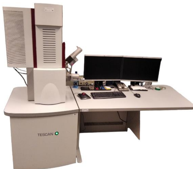
Rys. 5.10. Mikroskop skaningowy firmy TESCAN MIRA3
