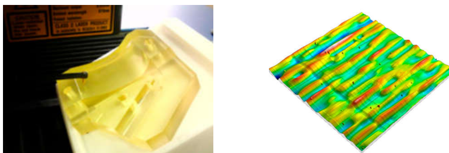
Rys. 40. Pomiar topografii powierzchni metodą stykową profilową: a) stanowisko pomiarowe, b) przykładowa wizualizacja topografii gniazda formy [A14]
