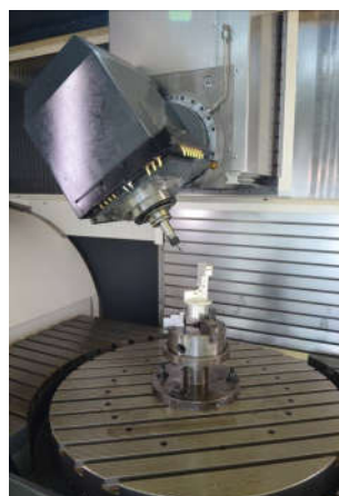
Rys. 27. Proces opracowania modelu wzorcowego, a) zamodelowany wzornik, b) model w trakcie wykonania na centrum obróbkowym DMU 100monoBLOCK [A11]
