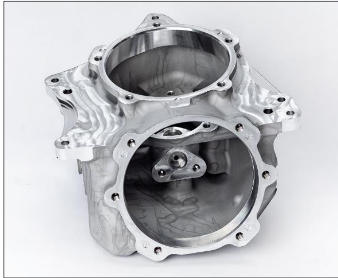
Rysunek 5.5. Korpus przekładni kątowej, element przeniesienia napędu przekładni akcesoriów ADT; Źródło: zdjęcie własne
