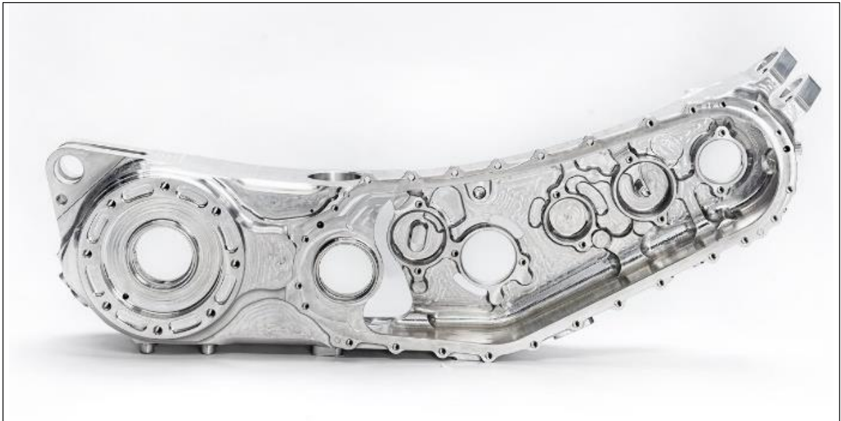
Rysunek 5.3. Kadłub główny przekładni akcesoriów ADT; Źródło: zdjęcie własne
