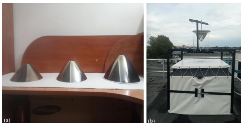
Rysunek 8. Układ rejestracji dookólnej wyładowań atmosferycznych: (a) prototypy zwierciadeł dookólnych wykonanych w technologii CNC; (b) system rejestracji dookólnej zainstalowany na dachu PRz [A7]
