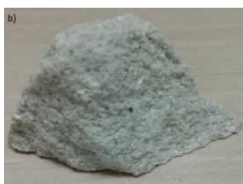
b) Fragment – przekłamy cegły silikatowej wyprodukowanej w 50%-ach na bazie GS i w 50%-ach z QS.
