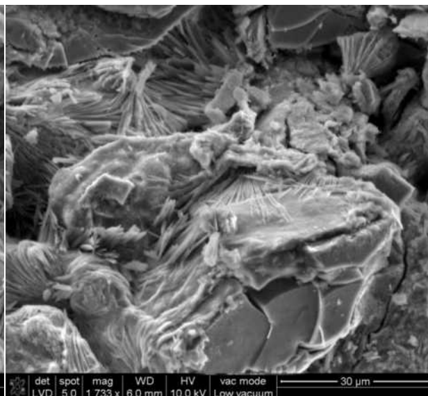
Rys. 70. Analiza mikrostruktury (SEM) cegieł wykonanych w 50% z udziałem QS i w 50-ach z GS. Test wykonano po 3 latach od daty produkcji cegieł. Powiększenie: 1 733 x, skala: µm.
