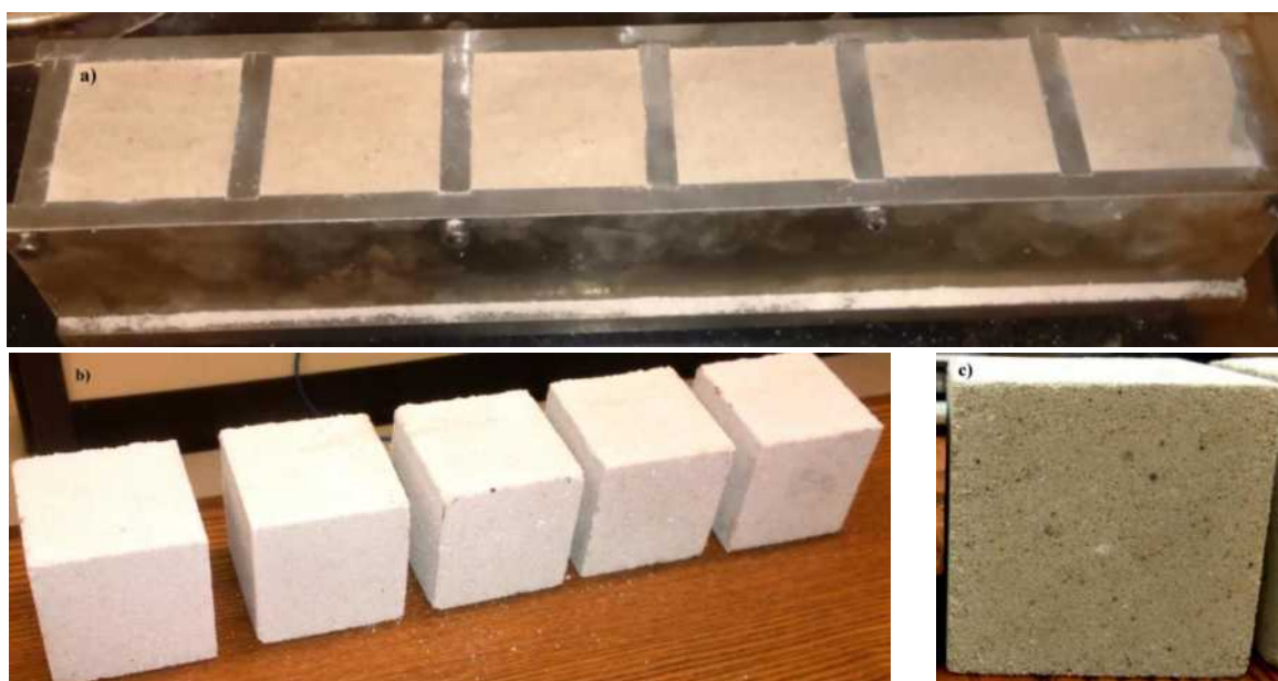
Rys. 26. Produkcja cegieł silikatowych w warunkach laboratoryjnych: a) formy z masą silikatową; b) cegły silikatowe tradycyjne wyprodukowane na bazie piasku kwarcowego; c) cegła silikatowa wyprodukowana w 90% na bazie piasku szklanego z dodatkiem CaO (7%) i H 2 O (3%).
