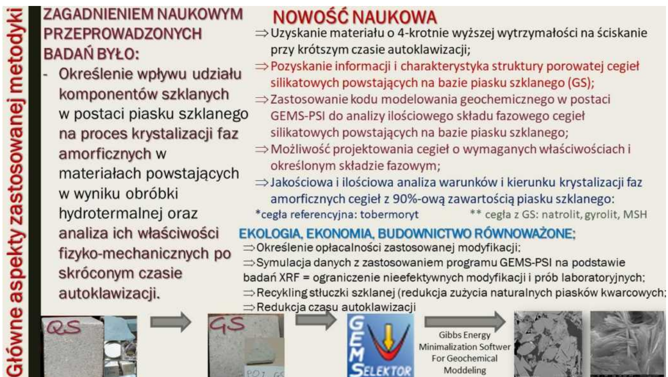
Rys. 91. Sumaryczne zestawienie głównych aspektów zaproponowanej modyfikacji tj. możliwość zastosowania piasku szklanego GS z recyklingu szkła butelkowego do produkcji cegieł silikatowych powstających w procesie autoklawizacji.
