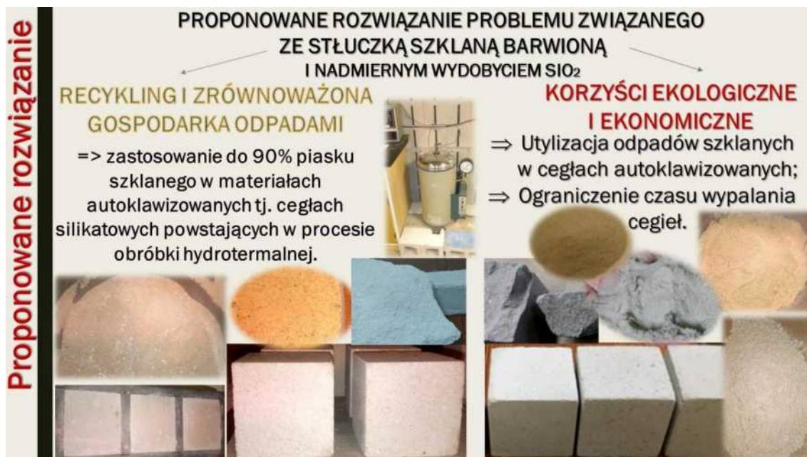
Rys. 25. Schemat i metodyka badań cegieł wapienno-piaskowych wg zastosowanej modyfikacji.
