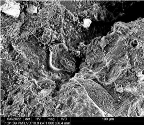
Rys. 56. Obraz mikrostruktury w tradycyjnej cegle silikatowej – widoczne ziarno SiO 2 i pory. Skala:
