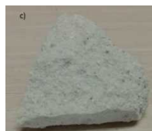
c) Fragment cegły silikatowej wyprodukowanej na bazie piasku szklanego tj. 90% GS + 7% CaO + 3% H 2 O w warunkach laboratoryjnych.
