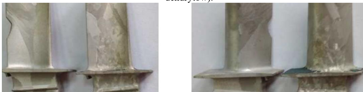
Rys. 4. Łopatki Turbiny Sprężarki, stan trawiony.
