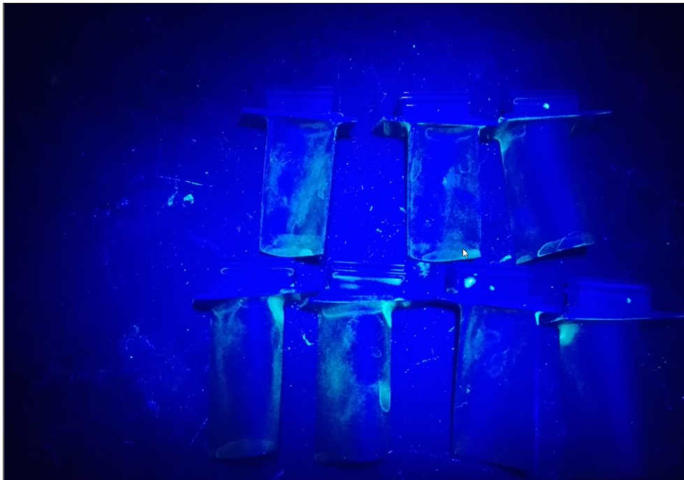
Rys. 155. Wyniki kontroli FPI ze wskazaniem nieciągłości na Łopatkach Turbiny Sprężarki.
