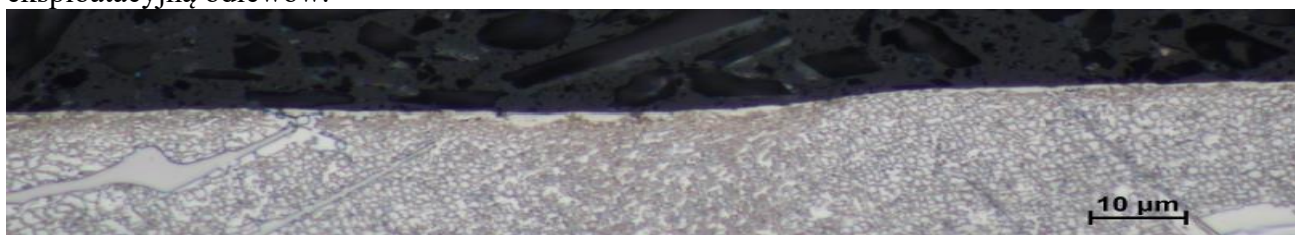
Rys. 170. Mikrostruktura łopatki nr N68, przekrój I, trawiony odczynnikiem AG-21, biała warstwa.
