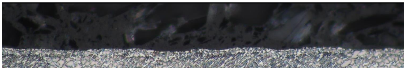
Rys. 177. Mikrostruktura łopatki nr N70, przekrój II, trawiony odczynnikiem AG-21, słabe odkształcenie.
