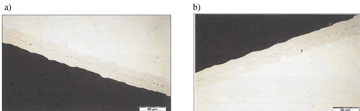
Rys. 149. Mikrostruktura warstwy aluminidkowej modyfikowanej renem wytworzonej na grzbiecie łopatkki nr 1 z nadstopu ŻS6U-WI, zgląd nietrawiony: a) grzbiet, b) koryto.
