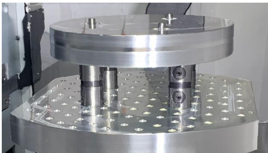
Rys. 2.2. Przykład modułowego systemu mocowania firmy IMAO [33]
