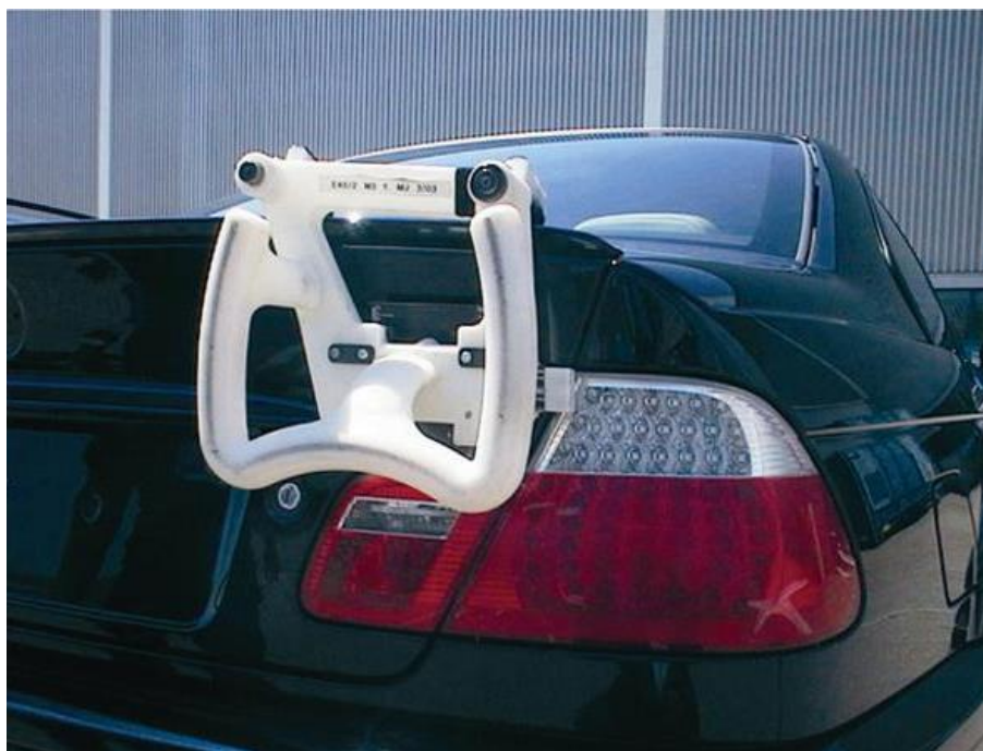
Rys. 2.5 Oprzyrządowanie wykorzystywane w firmie BMW do poprawnego umiejscowienia tylnej plakietki z oznaczeniem modelu [99].
