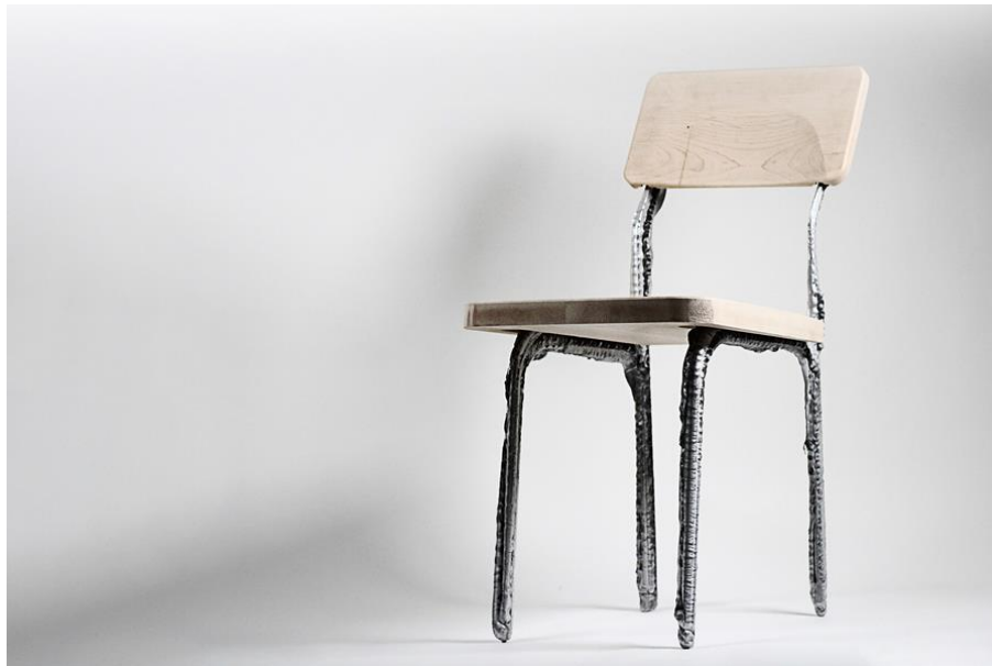
Rys. 2.9. Pełnowymiarowe krzesło wydrukowane za pomocą metody LMP [149]
