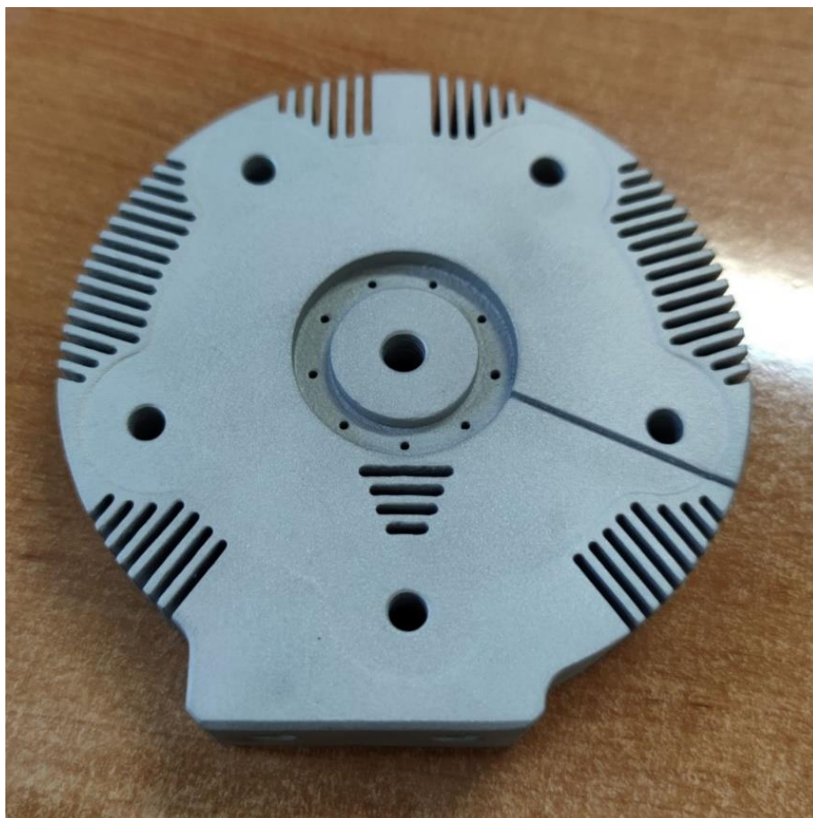
Rys. 4.15. Wydrukowany reprezentatywny uchwyt przed obróbką wykańczającą z materiału AlSi10Mg
