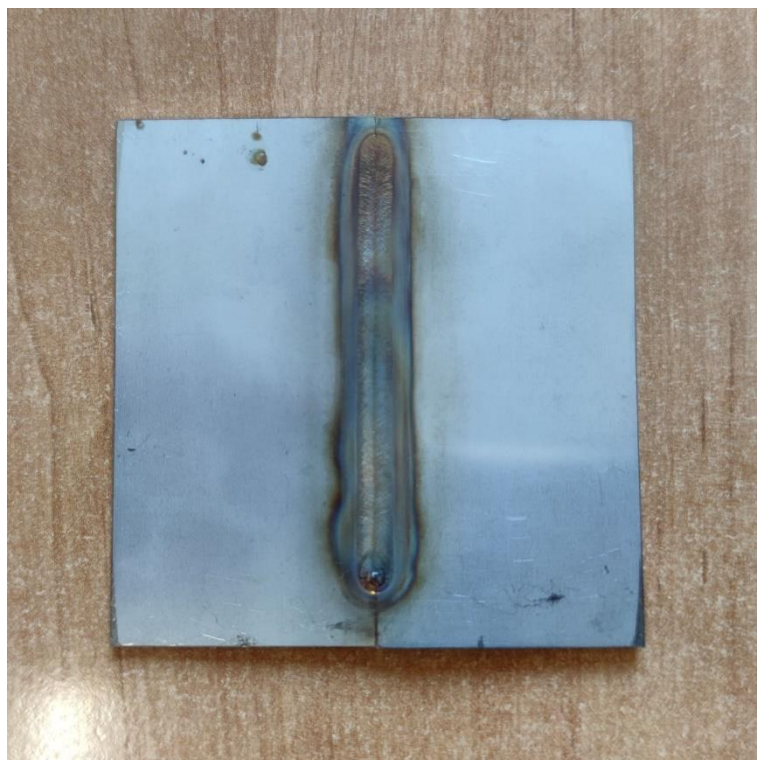
Rys. 4.22. Pospawana reprezentatywna próbka do celów ustalenia parametrów symulacji
