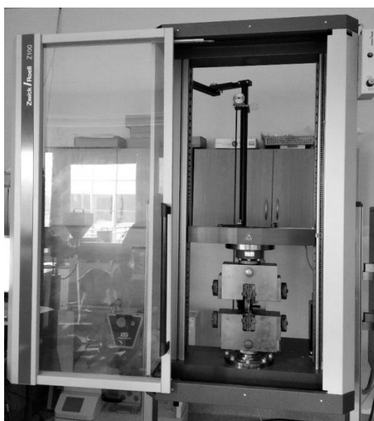
Rys. 5.16. Maszyna wytrzymałościowa ZWICK/ROELL Z100 (a) oraz próbka umieszczona w szczękach maszyny (b) [opracowanie własne]
