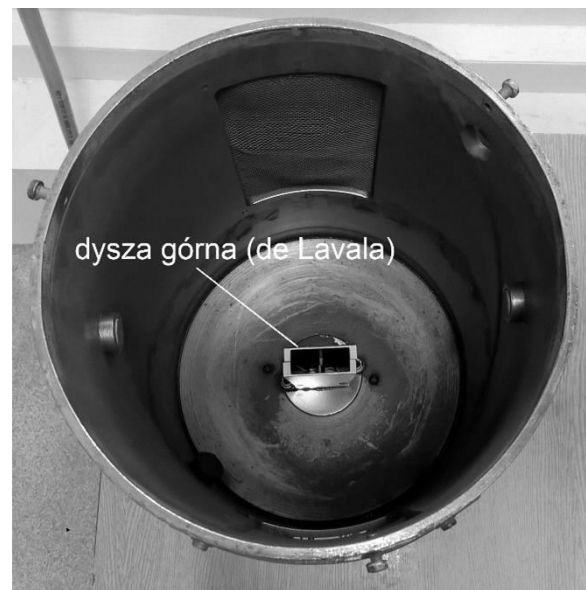
Rys. 5.7. Urządzenie do pneumokulkowania: widok ogólny (a), próbka zamocowana do pokrywy (b), wnętrze komory roboczej (c) [opracowanie własne]
