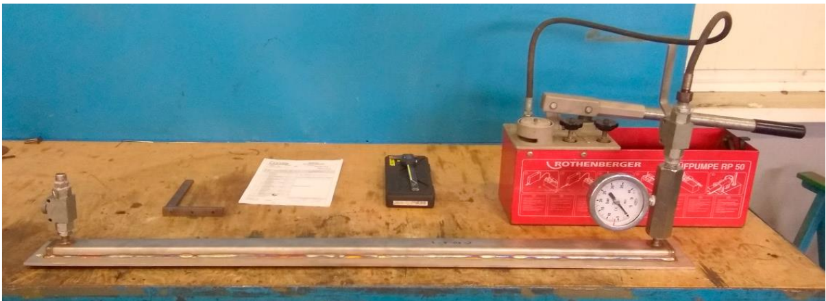
Rys. 24. Widok stanowiska do prób hydrostatycznych testowych profili węzownicy o długości 1200 mm, celem zbadania ich podatności na odkształcenie
