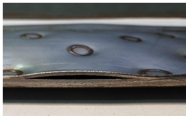
Rys. 1. Widok zbiornika procesowego z płaszczowym wymiennikiem ciepła oraz wycinek płaszczowego wymiennika ciepła
