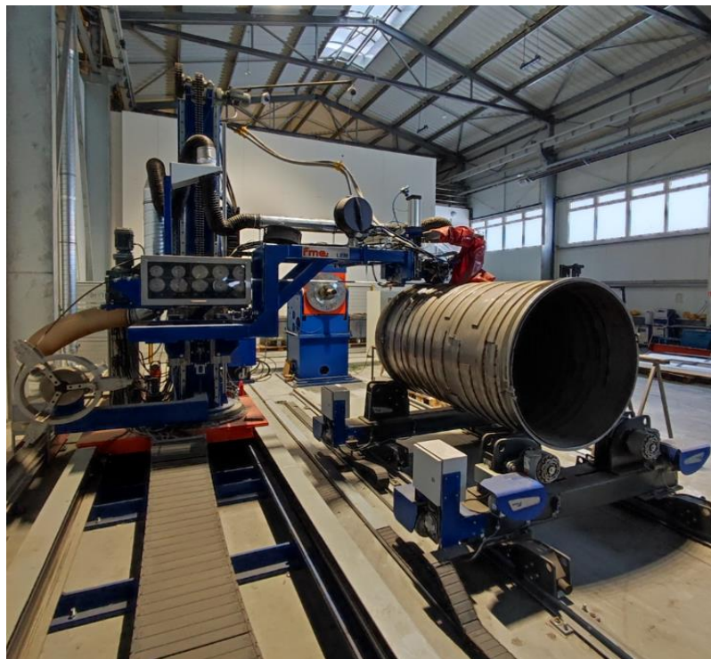
Rys.29. Zautomatyzowane stanowisko do wykonywania wężownicy na płaszczu zbiornika testowego wraz z walcarką do kształtowania profilu
