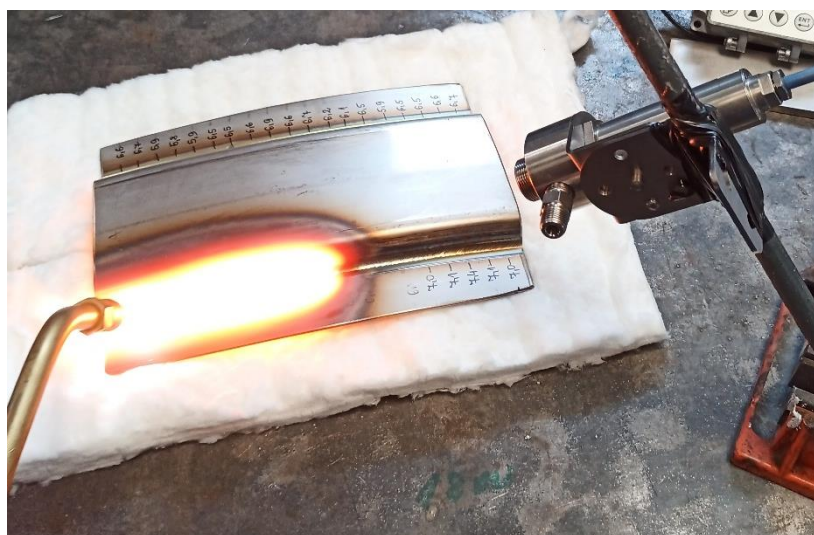
Rys. 34. Widok nagrzewanego palnikiem gazowym odcinka spoiny w testach obróbki pospawalniczej
