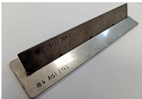
Rys. 17. Widok przykładowej próbki o grubości podstawy równej 4 mm (stal AISI 316L) i ustawionej pod kątem 60° płytki o grubości 1,5 mm (stal AISI 304L) - a). Widok dotychczas stosowanego w procesie wytwarzania profilu węzownicy wymiennika ciepła, spawanego do płaszcza zbiornika metodą TIG - b)
