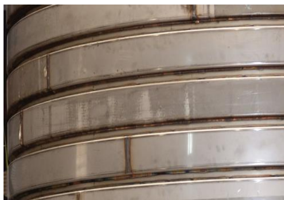
Rys. 17. Widok przykładowej próbki o grubości podstawy równej 4 mm (stal AISI 316L) i ustawionej pod kątem 60° płytki o grubości 1,5 mm (stal AISI 304L) - a). Widok dotychczas stosowanego w procesie wytwarzania profilu węzownicy wymiennika ciepła, spawanego do płaszcza zbiornika metodą TIG - b)
