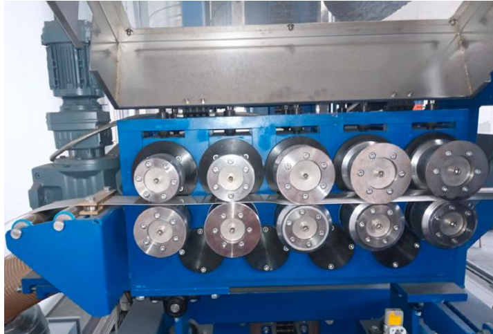
Rys. 27. Widok 5 par kół walcarki rolkowej kształtujących plastycznie profil węzownicy
