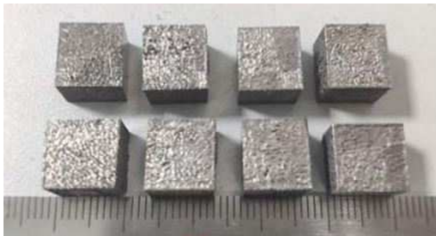
Rys. 4.12. Sześcienne kostki do badań mikrostruktury i porowatości
