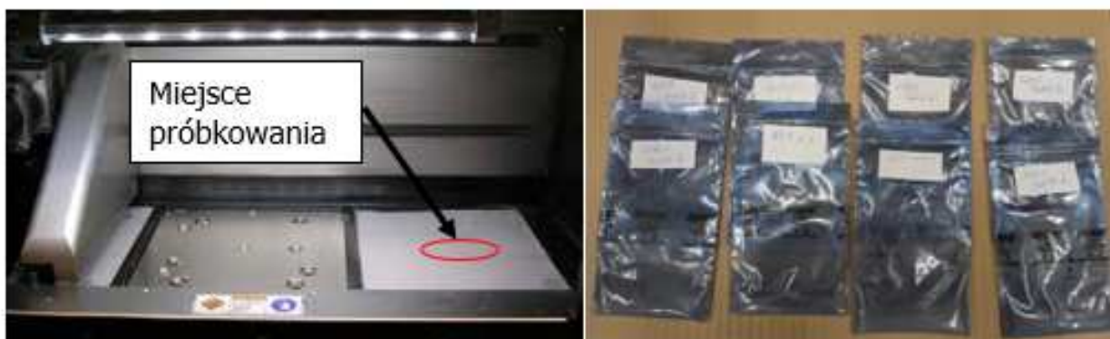
Rys. 4.13. Miejsce poboru proszku do badań złoża i próbki pobranego proszku złoża PBF
