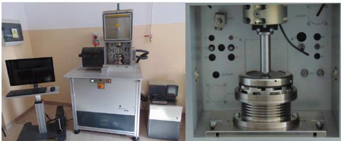
Rys.4.25. Stanowisko badawcze składające się z testera trybologicznego OPTIMOL SRV5 oraz powiększony widok na komorę pomiarową urządzenia, w której zamontowany jest standardowy moduł rotacyjny
