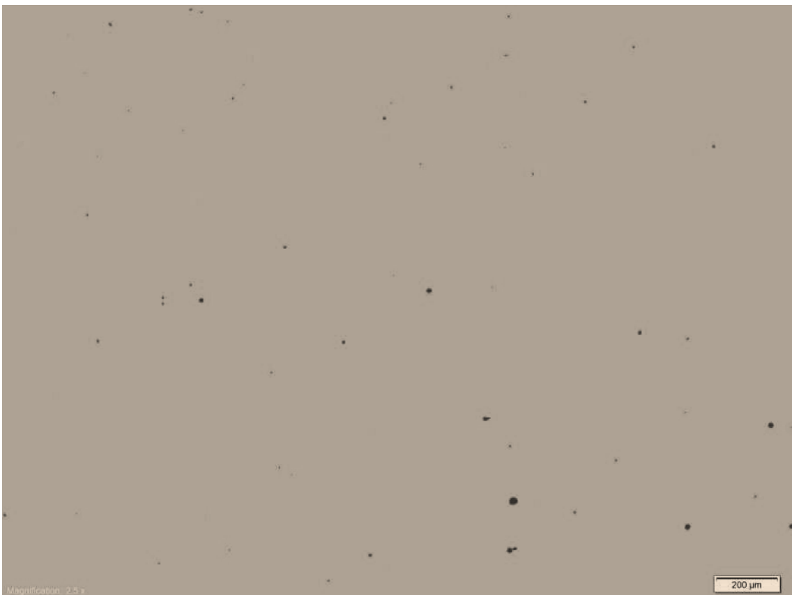
Rys. 5.21. Porowatość próbki wykonanej w procesie DMLS dla złoża Z2
