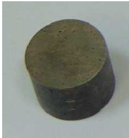
Rys. 4.27. Trzpień stanowiący przeciw-próbkę dla tarczy wykonany ze stali maraging 1.2709 – SLM
