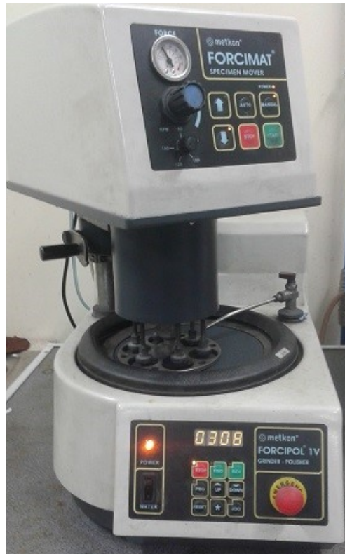
Rys. 4.18. Stacja do szlifowania powierzchni zglądu FORCIMAT
