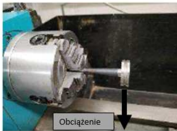
Rys. 5.30. Próbkę do badań obrotowo giętych umieszczoną na stanowisku badawczym
