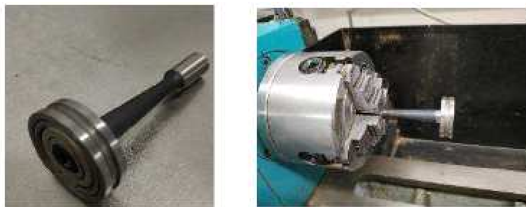
Rys. 4.46. Po lewej próbka z pierścieniem obrotowym, po prawej próbka w uchwycie 4 szczękowym
