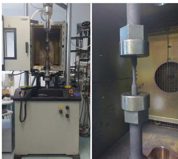
Rys. 4.24. Hydrauliczna maszyna wytrzymałościowa INSTRON 8801: a) widok ogólny, b) uchwyty z zamocowaną próbką
