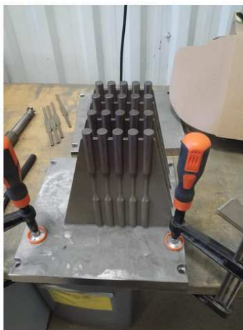
Rys. 4.22. Próбки do badań po procesie SLM
