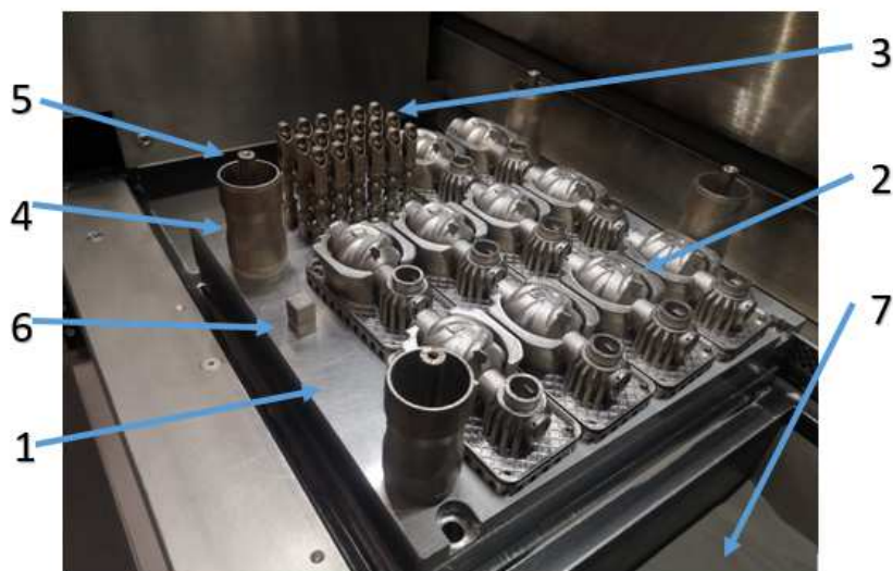
Rys. 4.33. Płyta drukowa komponentów L050: 1 płyta startowa; 2 korpus serwowozaworu, 3 rozdzielacz serwowozaworu, 4 próbka do badań ciśnieniowych, 5 próbka do badań obrotowo-giętych, 6 próbka do badań porowatości, 7 złoże proszkowe
