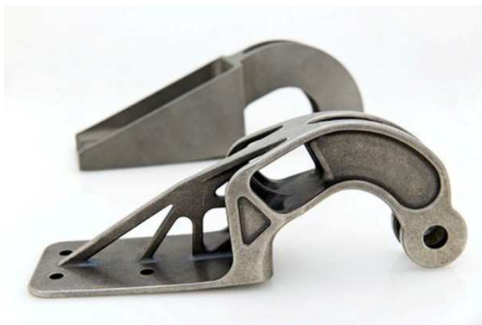
Rys. 1.2. Wspornik zawiasu Airbus A320 wykonany metodą przyrostową na tle wspornika klasycznego [24]
