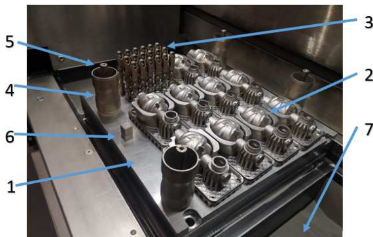
Rys. 5.23. Płyta druku komponentów L050: 1 płyta startowa; 2 korpus serwozaworu, 3 rozdzielacz serwozaworu, 4 próbka do badań ciśnieniowych, 5 próbka do badań obrotowo giętych, 6 próbka do badań porowatości, 7 złożo proszkowe
