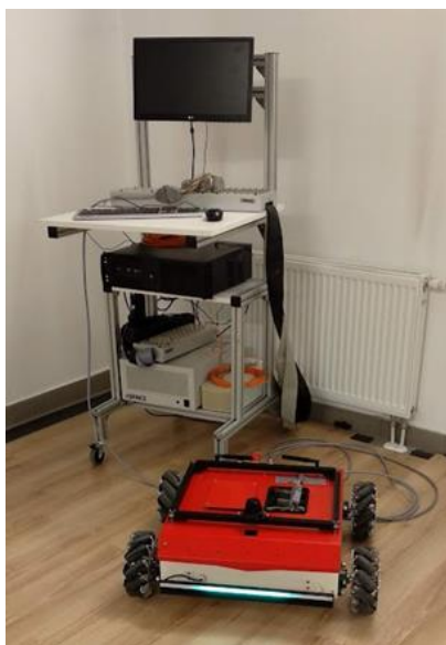
Rys. VI.1. Stanowisko szybkiego prototypowania
