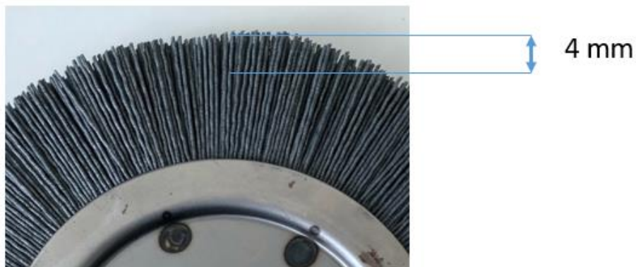
Rys. 14. Miejsce pomiaru grubości włosa po przeprowadzonym teście.
