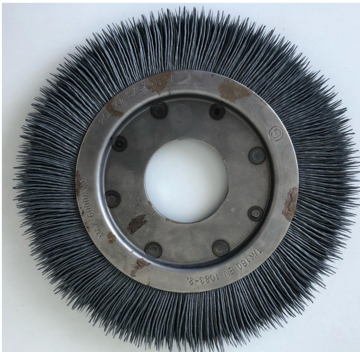
Rys. 20. Szczotka w stanie zużytym.
