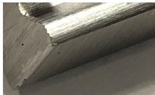
Rys. 37. Stan krawędzi przed operacją szczotkowania – zamek łopatk, widok z boku.
