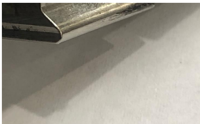
Rys. 40. Stan krawędzi po przeprowadzeniu operacji szcztokowania z wykorzystaniem opracowanych parametrów technologicznych – zamek łopatkki, widok z tyłu.
