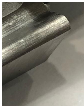
Rys. 39. Stan krawędzi przed operacją szcztokowania – zamek łopatkki, widok z boku.
