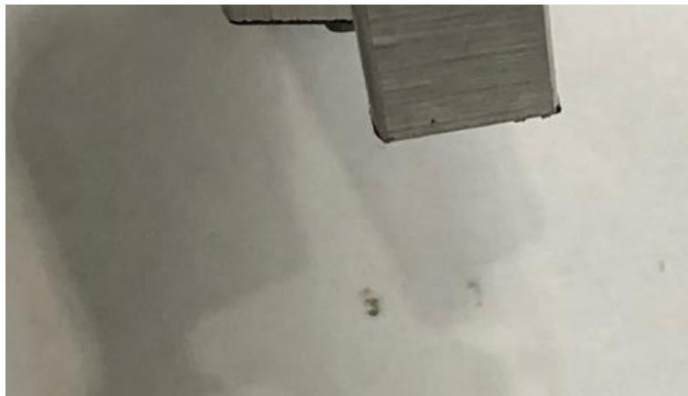
Rys. 38. Stan krawędzi przed operacją szczotkowania – zamek łopatk, widok z tyłu.
