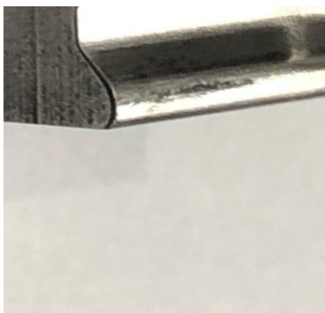
Rys. 41. Stan krawędzi po przeprowadzeniu operacji szcztokowania z wykorzystaniem opracowanych parametrów technologicznych – zamek łopatkki, widok z boku.
