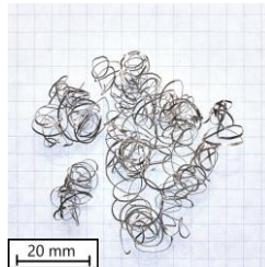
Rys. 5.49 Porównanie kształtu wiórów po toczeniu stopu Ti-6Al-4V dla pkt. 2 planu ( f=0,133 mm/obr, a_p=0,35 mm).
