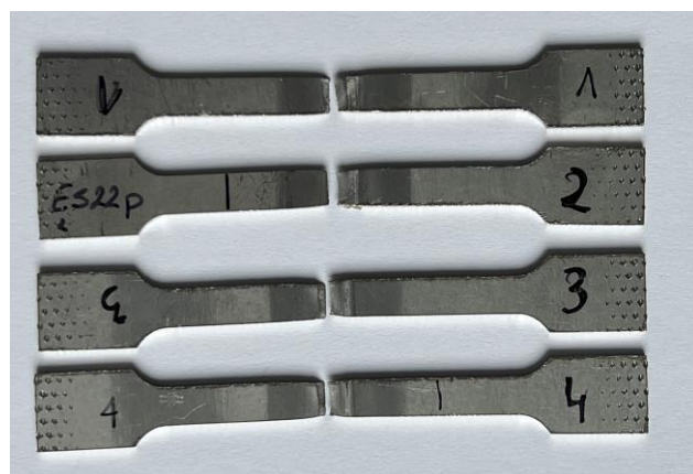
Rys. 5.19. Przykładowe próbki po statycznej próbie rozciągania – widoczne zerwanie próbek na granicy strefy wpływu ciepła
