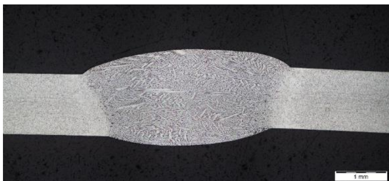
Rys. 5.53. Mikrostruktura złącza spawanego próbki TI13p (stan po „finalnej obróbce cieplnej”)
