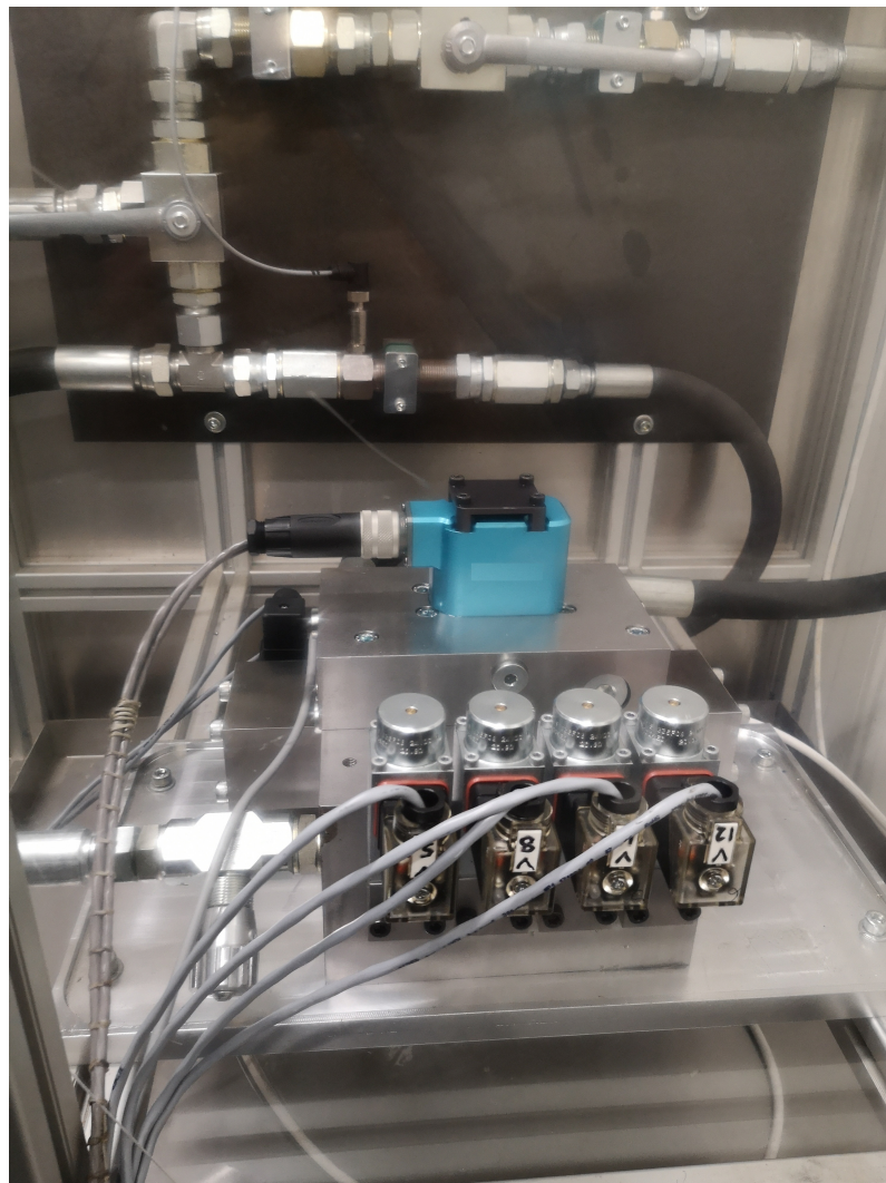
Rys. 6.4. Badany serwo-zawór zamontowany na stanowisku w komorze testowej
