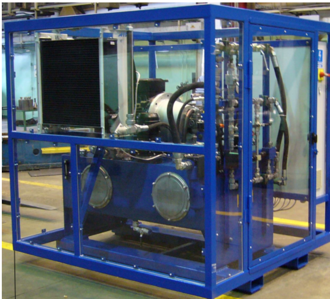
Rys. 6.1. Zasilacz hydrauliczny wykorzystany do testów zaworów i siłownika
