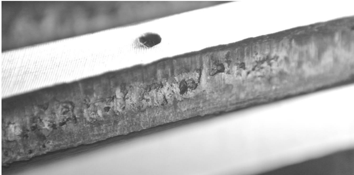
Rys. 4.10 Makrofotografia pittingu na powierzchni zęba zębownika przekładni Nowikowa
