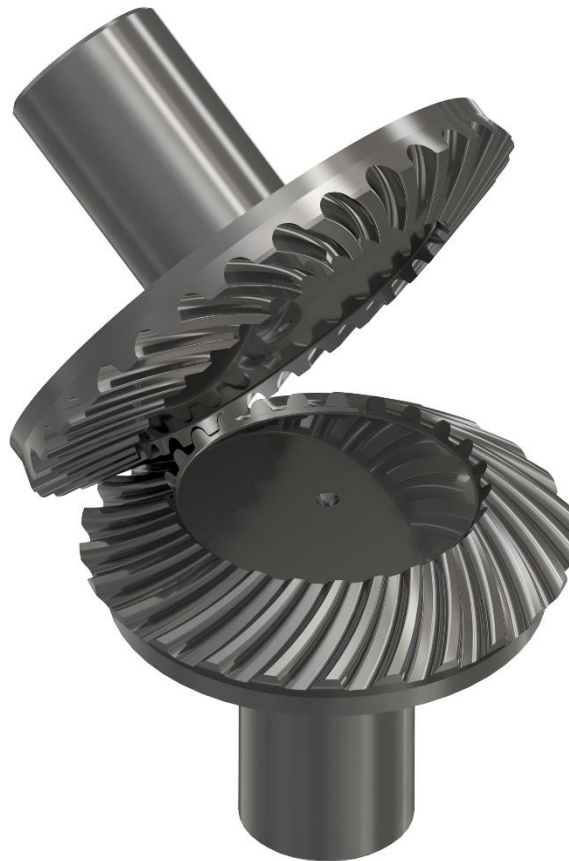
Rys. 4.26 Przykładowy model 3D CAD przekładni stożkowej typu Nowikowa
