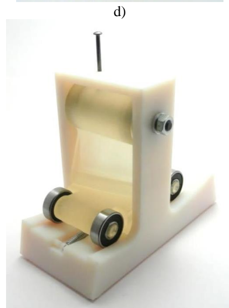
Rys. 4.1 Stanowiska badawcze: a) model stanowiska z ząbieniem zewnętrznym, b) wykonane stanowisko z ząbieniem zewnętrznym, c) model stanowiska z ząbieniem wewnętrznym, d) wykonane stanowisko z ząbieniem wewnętrznym
