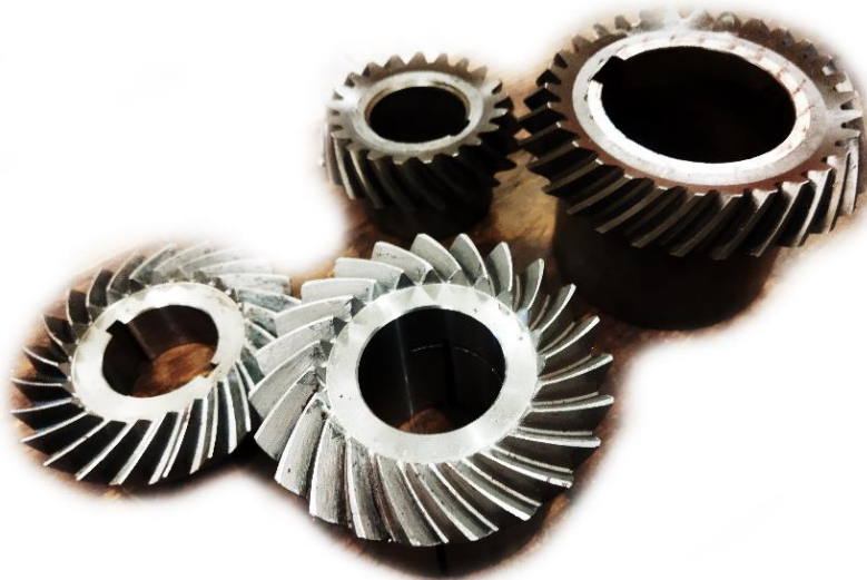
Rys. 4.35 Wykonane uzębienia kół stożkowych
