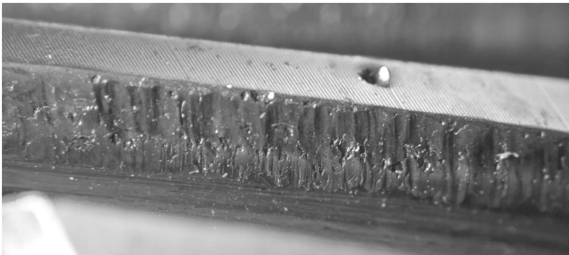
Rys. 4.11 Makrofotografia pittingu na powierzchni zęba koła przekładni Nowikowa
