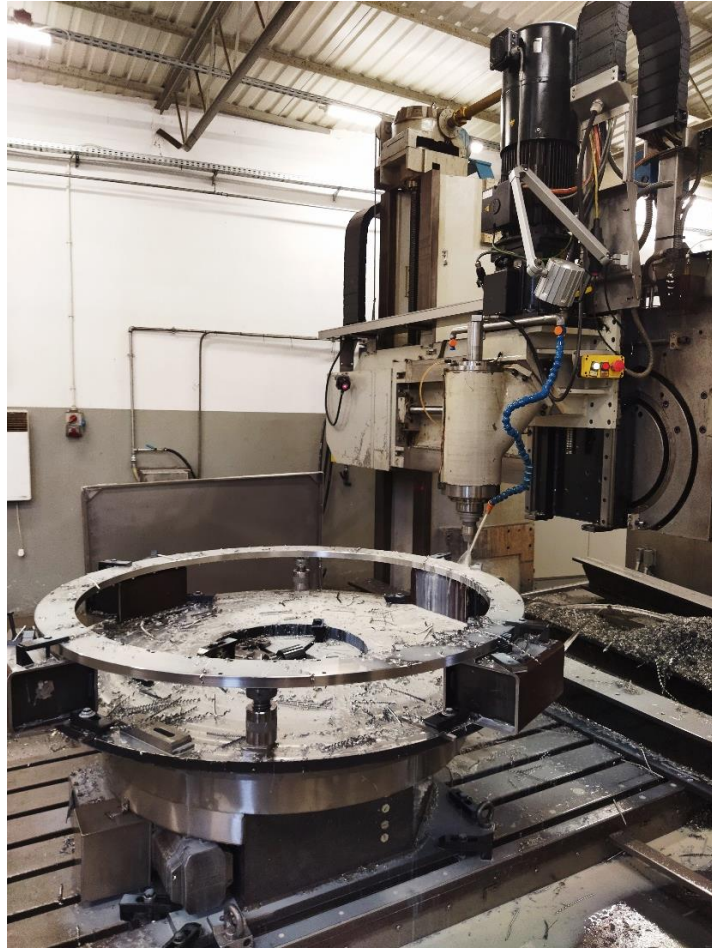
Rys. 4.36 Dwupołożeniowy wrzeciennik frezarki bramowej
