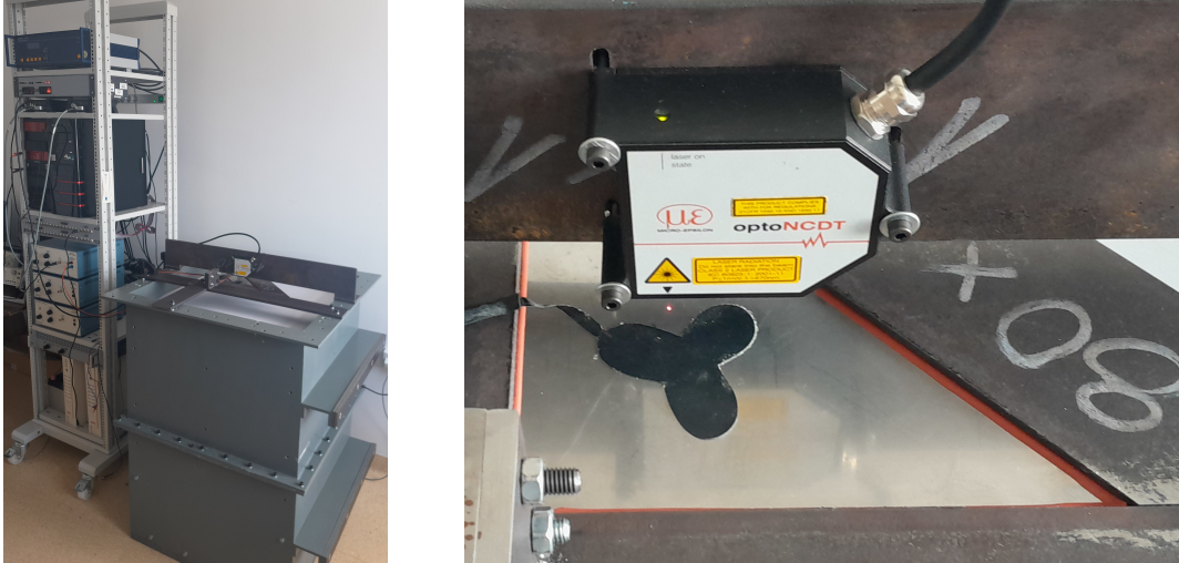
Rys. 4.4 Stanowisko badawcze (po lewej), zamontowana płyta z a-PZT (po prawej).
