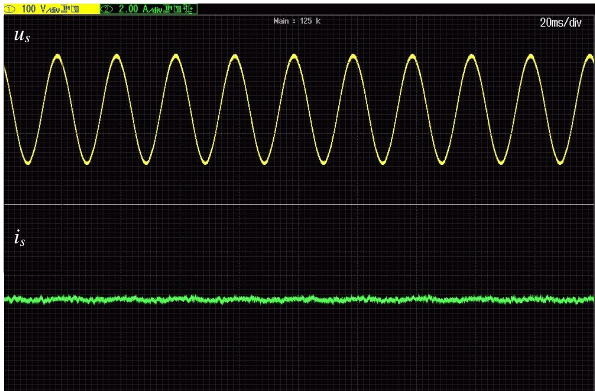
Rys. 7.5. Przebiegi napięcia i prądu linii zasilającej – zadany prąd linii równy 0 A
