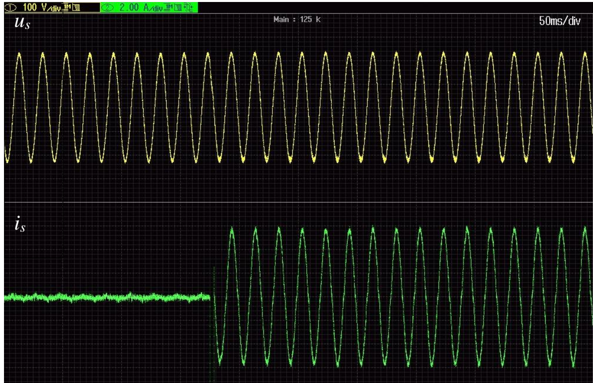
Rys. 7.39. Przebiegi napięcia i prądu w linii zasilającej, przy skokowej zmianie zadanej mocy czynnej z 0 na P_N
