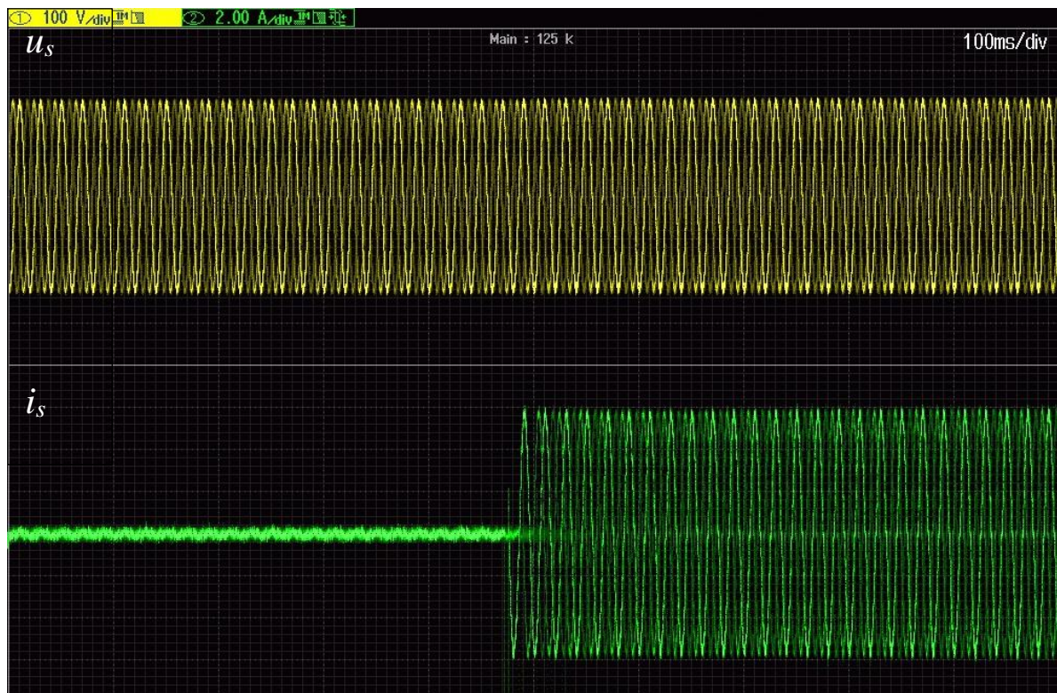
Rys. 7.6. Przebiegi napięcia i prądu linii zasilającej - rozruch urządzenia – skokowa zmiana zadanej mocy z 0 na P_N (0 na 6 A amplitudy prądu linii)
