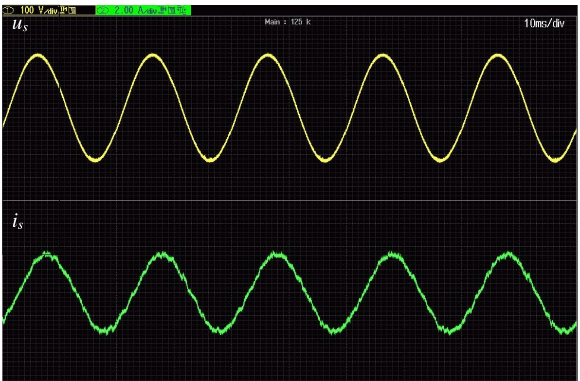
Rys. 7.38. Przebiegi napięcia i prądu linii zasilającej – zadana składowa czynna o amplitudzie 2A i składowa bierna o amplitudzie 1,8A o charakterze indukcyjnym
