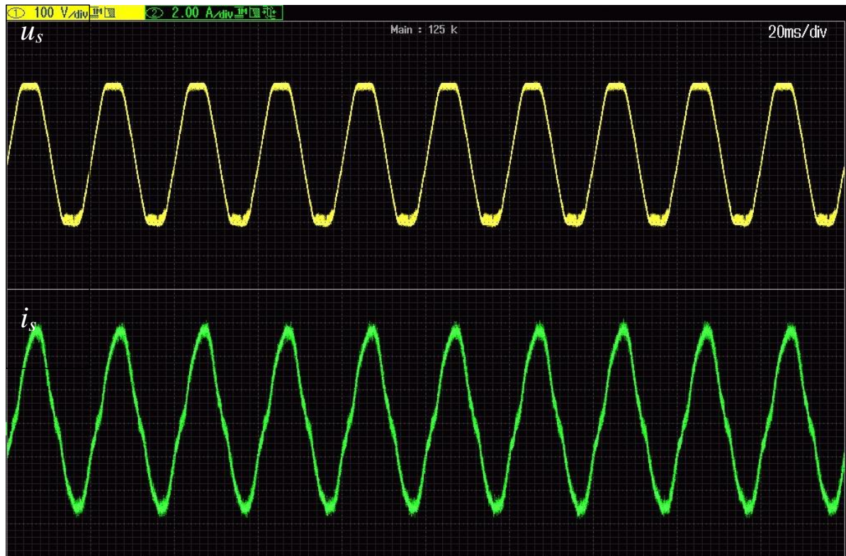
Rys. 7.19. Przebiegi napięcia i prądu linii zasilającej – stan ustalony przy odkształceniu napięcia zasilania ( THD_u=8\% ) zadaną amplitudą prądu linii 6 A
