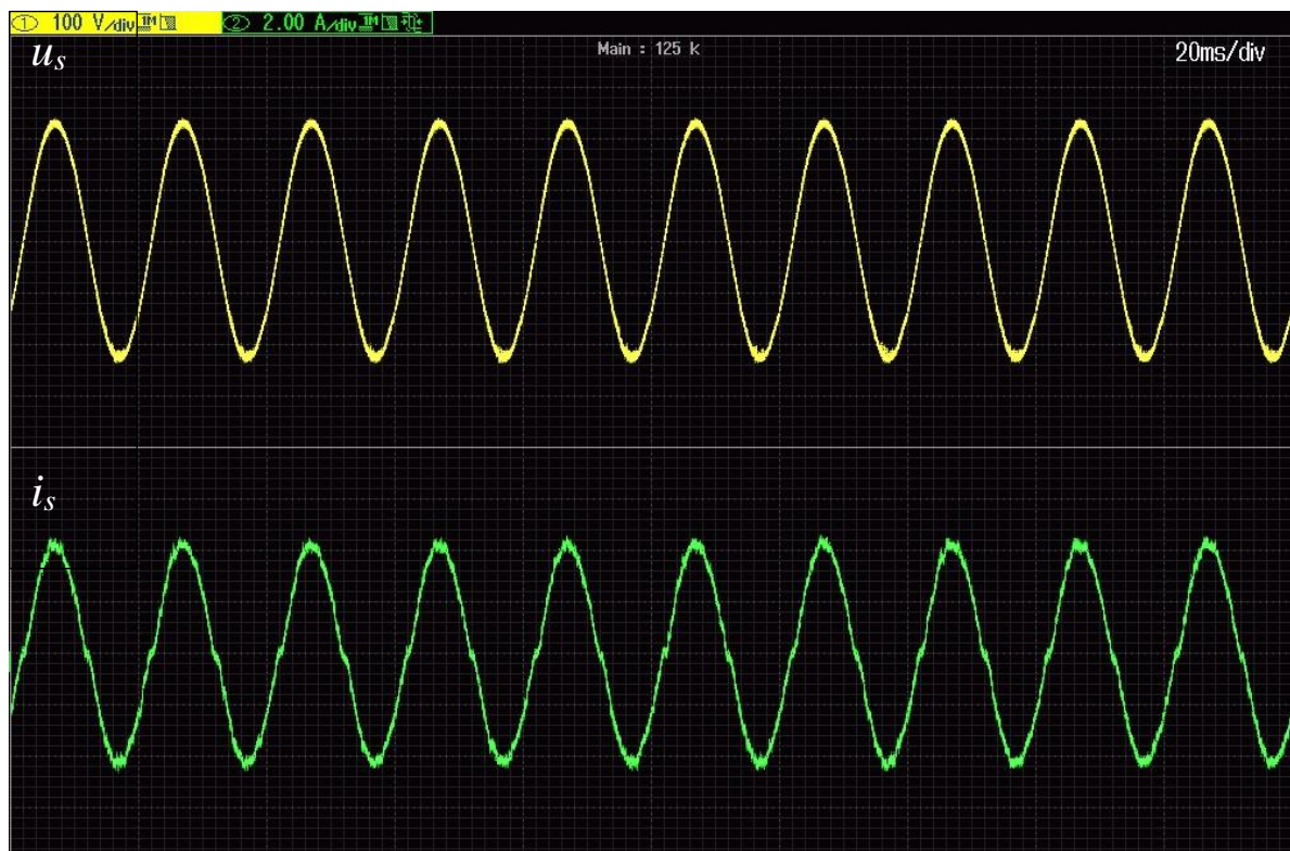
Rys. 7.12. Przebiegi napięcia i prądu linii zasilającej – stan ustalony z zadaną amplitudą prądu linii 4 A
