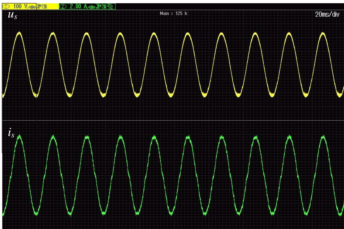
Rys. 7.21. Przebiegi napięcia i prądu linii zasilającej – stan ustalony dla częstotliwości napięcia zasilania większej niż częstotliwości rezonansowej regulatora ( f=51 Hz, f_R=50 Hz), przy zadanym prądzie linii o amplitudzie 6 A
