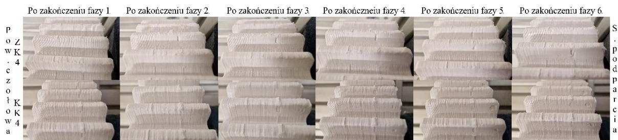
Rys. 10.41. Powierzchnie robocze zębów pary PK4 po każdej z faz badania trwałości
