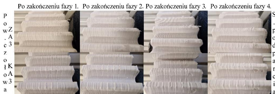
Rys. 10.52. Powierzchnia robocza zębów pary PA3 po przeprowadzeniu badania trwałości
