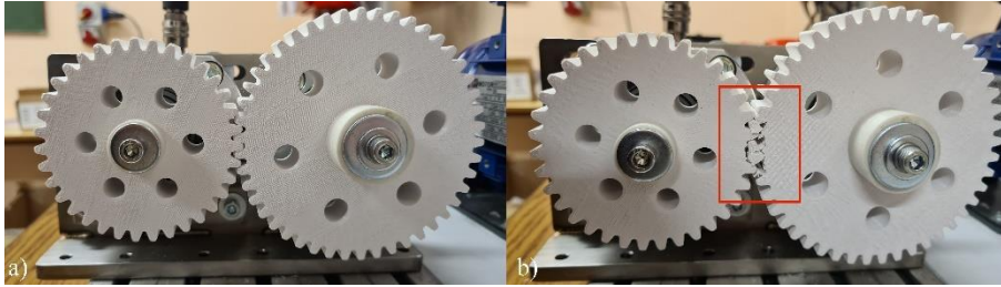
Rys. 10.8. Para kół PK2 przed (a) i po (b) wykonanej próbie wytrzymałościowej
