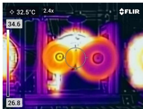
Rys. 10.38. Zdjęcie z kamery termowizyjnej pary PK3 pod koniec ostatniej, piątej fazy badania trwałości
