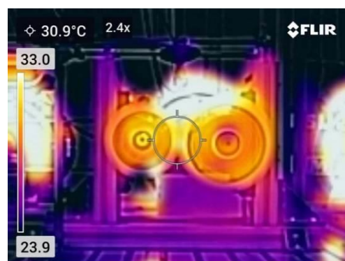
Rys. 10.64. Przykładowe zdjęcie termowizyjne wykonane pod koniec badania trwałości pary PA6
