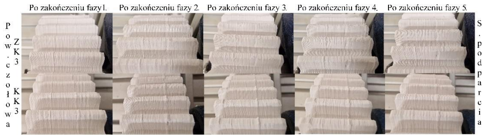
Rys. 10.36. Zużycie dogłębniejsze powierzchni roboczej zębów pary PK3 po przeprowadzeniu badania trwałości
