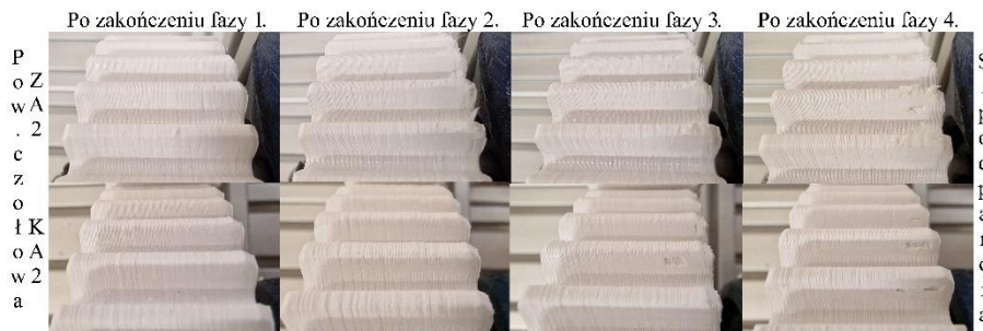
Rys. 10.51. Powierzchnie robocze zębów pary PA2 po każdej z faz badania trwałościowego
