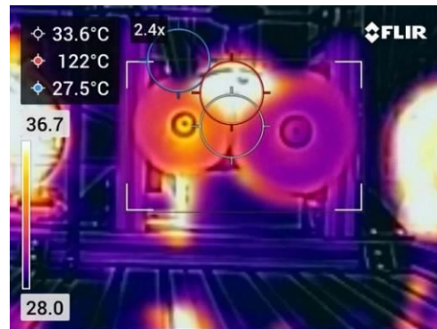
Rys. 10.30. Zdjęcie z kamery termowizyjnej FLIR C5 wykonane pod koniec badania trwałości pary PK1
