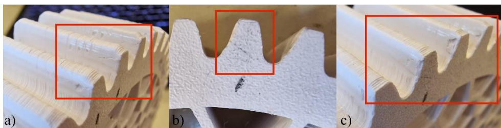
Rys. 10.63. Widok na uszkodzone zęby koła KA6 po wykonanym badaniu trwałości: (a, c) widok z boku od strony podparcia, (b) widok z góry od strony podparcia
