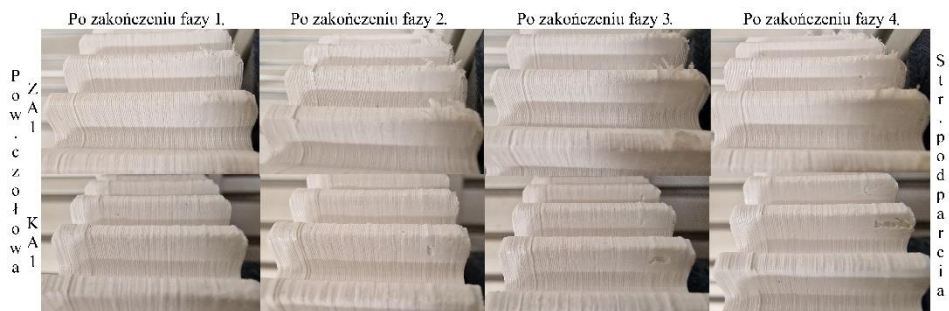
Rys. 10.46. Zużycie dogładzające powierzchni bocznej zębów pary PA1 po badaniu trwałościowym
