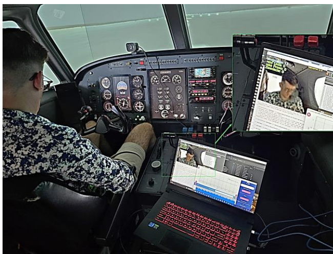
Rys. 16 System wizyjny umożliwiający określenie poziomu zmęczenia pilota.
