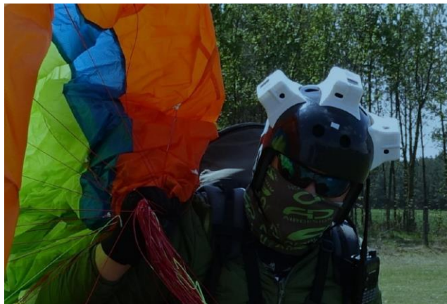
Rys. 17 System pomiaru położenia uchwytów sterowniczych podczas badań w locie
