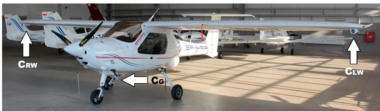
Rys. 4 Implantacja systemu wizyjnego na pokładzie samolotu.
