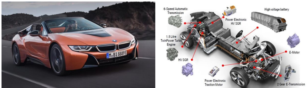
Rys. 2.4. BMW i8 i jego hybrydowy zespół napędowy [90]
