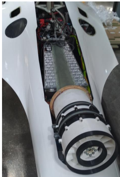
Rys. D.1. Widok na ogniwo wodorowe zainstalowane w płatowcu motoszybowca AOS H2
