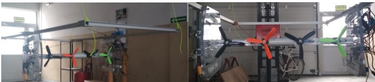
Rys. 11. Stanowisko do badań otunelowanego napędu rozproszonego
