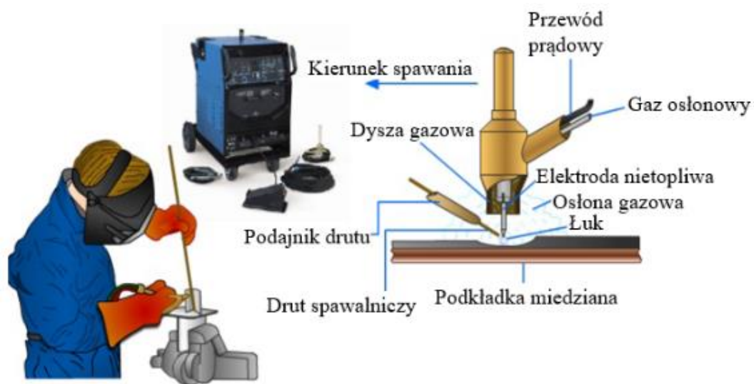
Rys. 15. Spawanie elektrodą nietopliwą w osłonie gazów obojętnych TIG (GTAW) [38]
