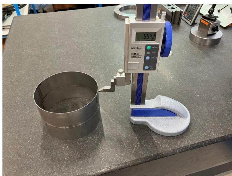
Rys. 72. Sposób pomiaru wysokości złącza próbnego
