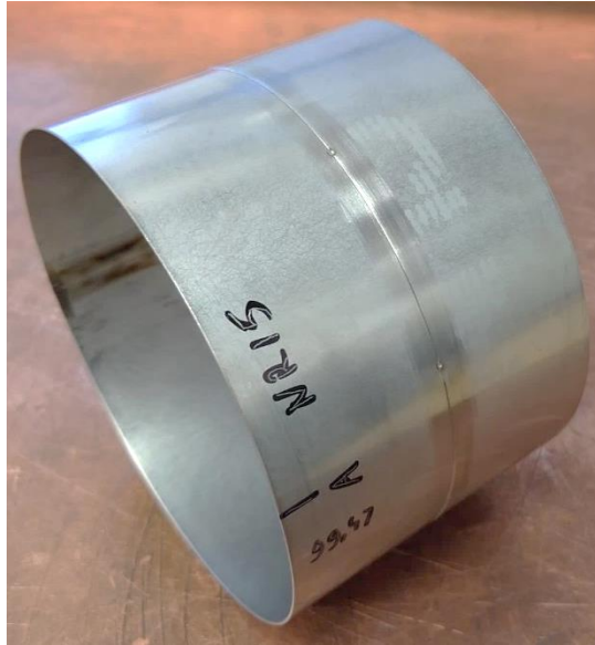
Rys. 50. Widok próbki przygotowanej do wykonania próbnego złącza spawanego
