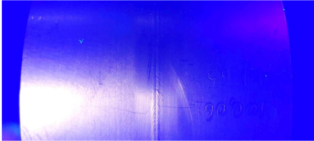
Rys. 101. Zdjęcie powierzchni złącza próbnego A.3 podczas kontroli FPI
