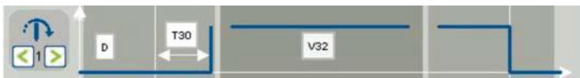
Rys. 56. Schematyczne przedstawienie funkcji obrotu uchwytu spawalniczego (stołu) [108]
