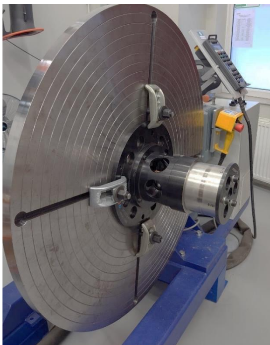
Rys. 66. Widok przyrządu na obrotniku, wraz z zamontowanym złączem próbnym
