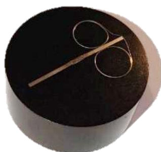
Rys. 130. Widok przygotowanego zglądu metalograficznego do obserwacji mikrostruktury
