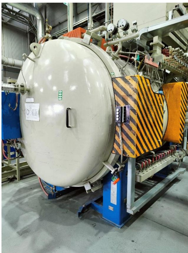
Rys. 106. Piec próżniowy Seco Warwick model 10.0VPT-4050/48HVN
