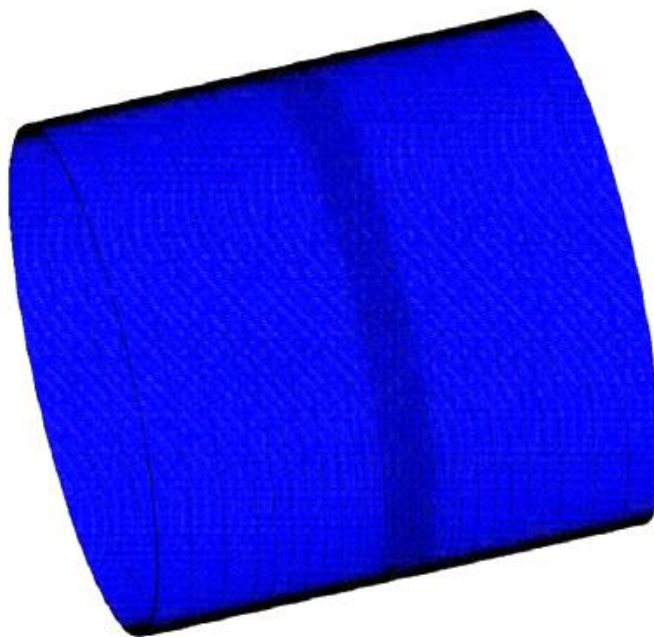
Rys. 38. Symulacja spawania obwodowego TIG: A) MES (FEM) model [69]
