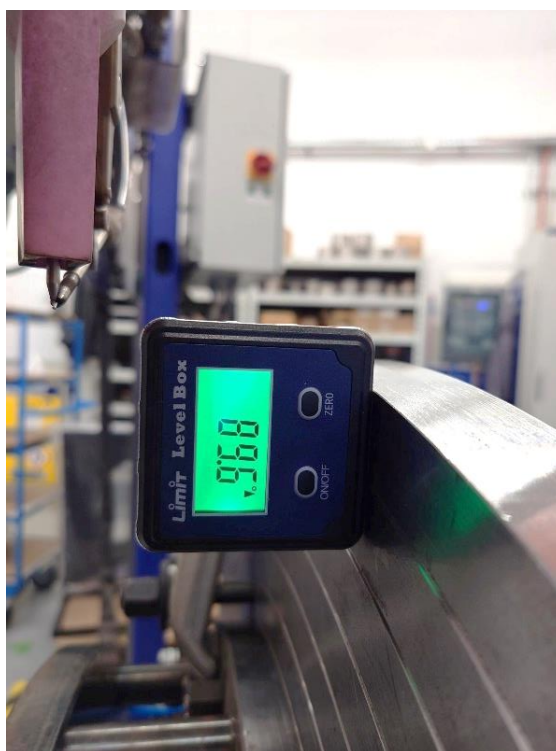
Rys. 62. Pomiar wartości kąta pochylenia stołu obrotnika
