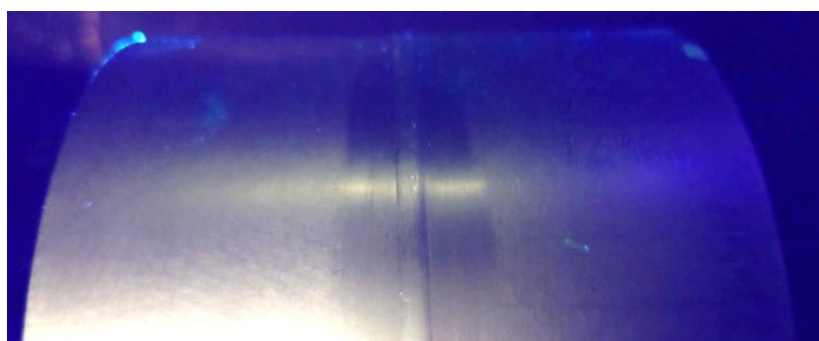
Rys. 100. Zdjęcie powierzchni złącza próbnego A.2 podczas kontroli FPI
