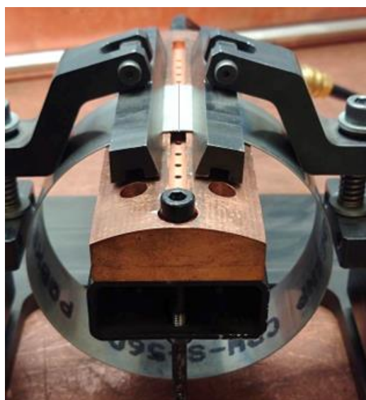
Rys. 49. Sposób mocowania blach w przyrządzie do spawania wzdłużnego
