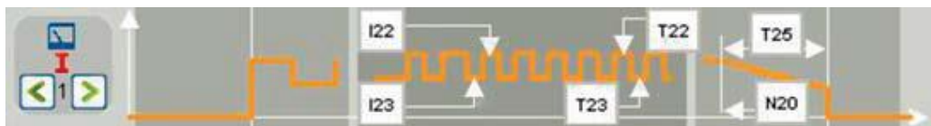
Rys. 53. Funkcje sterowania prądem na tablicy zasilacza Polysoude P6 CW [109]
