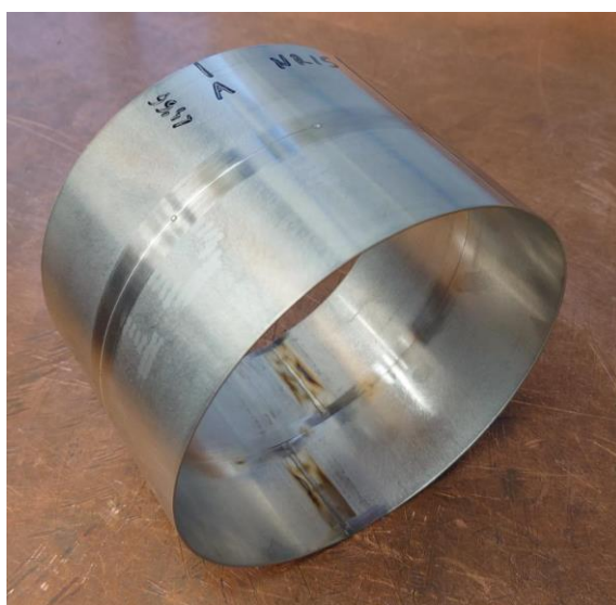
Rys. 71. Widok złącza próbnego przed spawaniem
