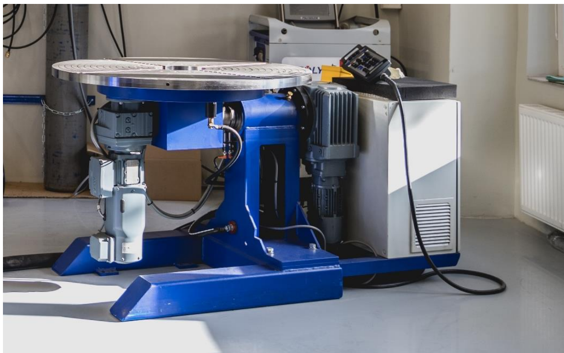
Rys. 61. Stół obrotowy, dwuosiowy o nośności 500 kg
