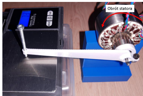
Rys.3.16 Stanowisko pomiaru momentu zaczepowego
