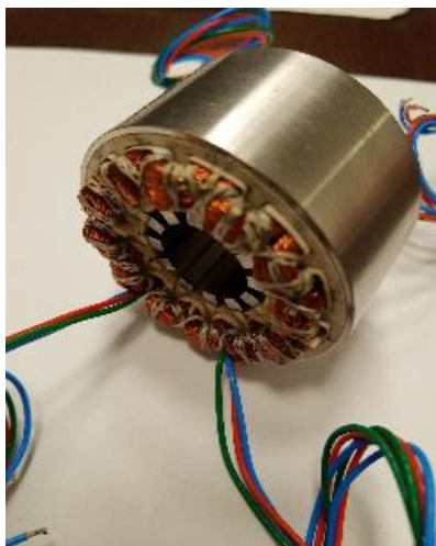
Rys.2.34. Silnik czterokanałowy podwójnego serwowaworu Yasa Poland [9]
