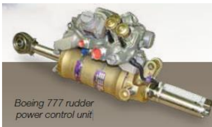
Rys.2.5. Jednostka sterująca mocą steru Boeing 777 [68]
