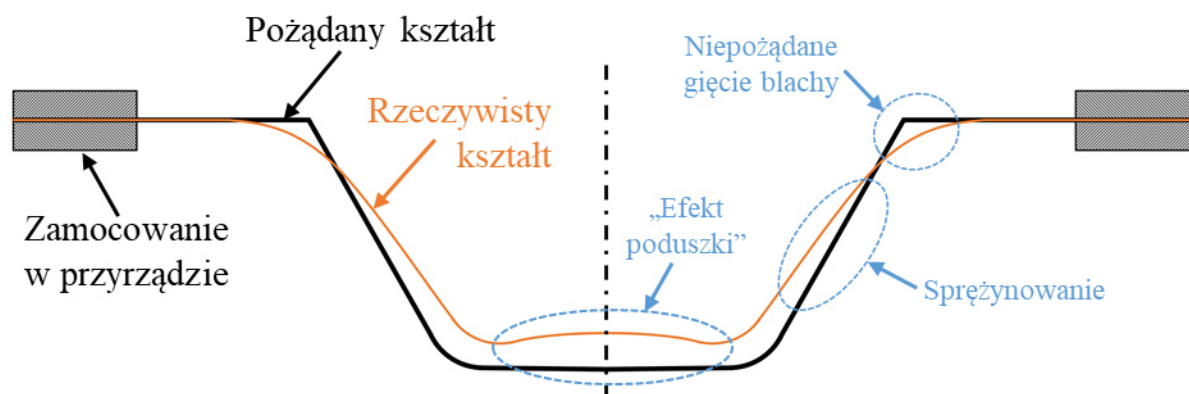
Rysunek 2.6. Niekorzystne efekty geometryczne występujące podczas kształtowania SPIF
