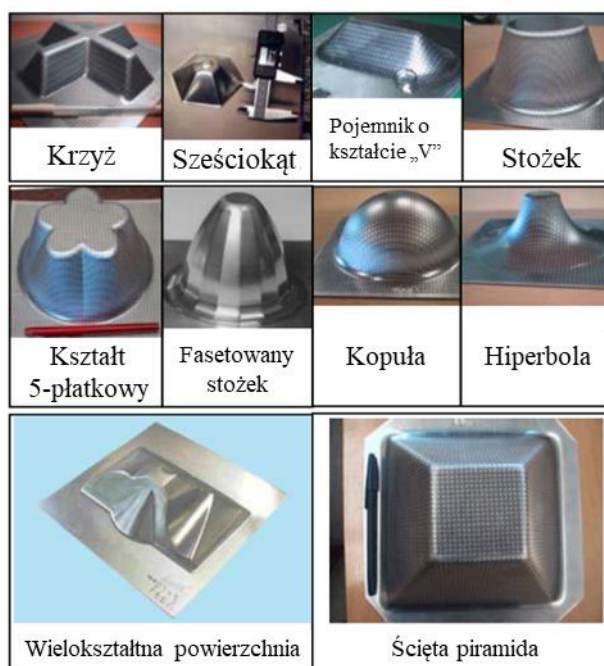
Rysunek 2.15. Kształty wytłoczek analizowane w testach porównawczych SPIF [195].
