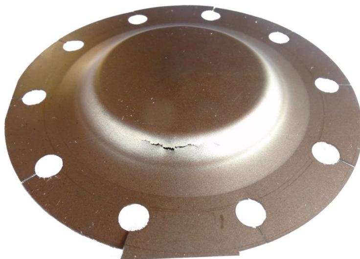
Rysunek 6.20. Widok wytłoczki z CP-Ti Gr 2 kształtowanej z następującymi parametrami obróbki: n = 600 obr/min, f = 2000 mm/min, a_p = 0,1 mm
