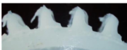
Rys. 6. Zużycie zębów powstałe na skutek działających obciążeń powodujących topienie się materiału POM [94]
