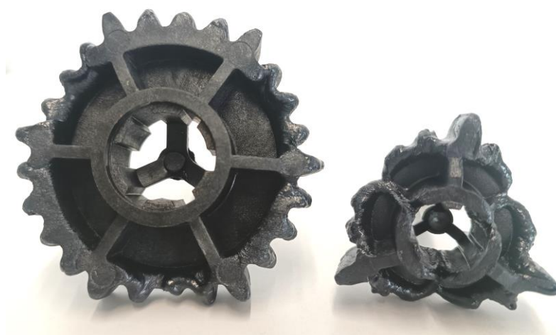
Rys. 64. Widok kół zębatach KZ25 i KZ17 otrzymanych w trakcie weryfikacji poprawności wypełniania gniazd formujących
