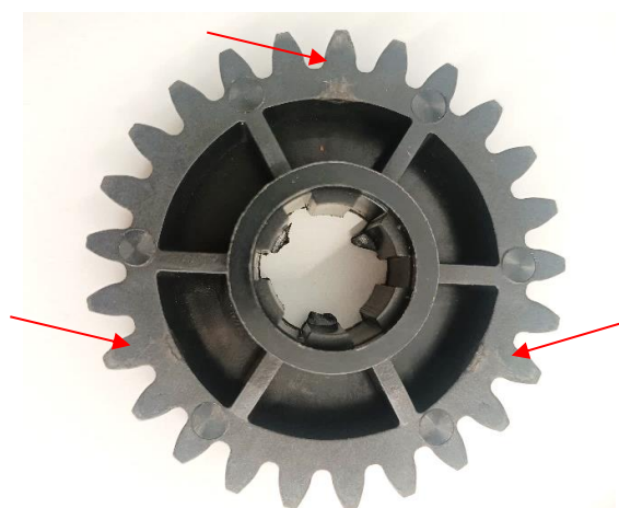
Rys. 66. Widok KZ25 z oznaczonymi przypaleniami w miejscu linii łączenia
