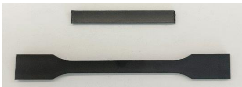
Rys. 30. Wygląd znormalizowanych próbek wykonanych w celu pomiaru własności mechanicznych tworzyw sztucznych
