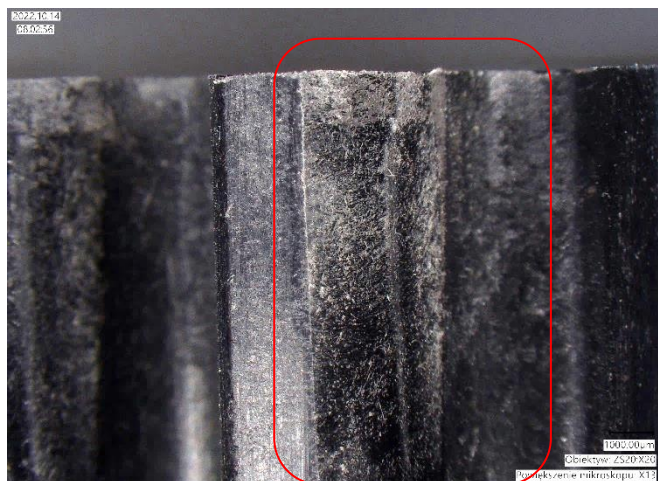
Rys. 104. Uszkodzenia kół zębatych PA66/6T/35GF występujące po teście trwałościowych zgodnym z parametrami przedstawionymi w tab. 25
