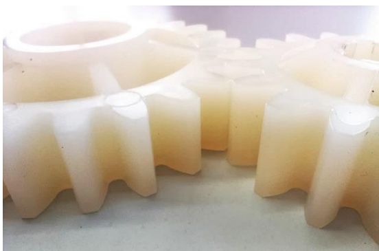
Rys. 87. Widok pary kół zębatych po teście trwałościowym, zgodnym z parametrami przedstawionymi w tab. 23
