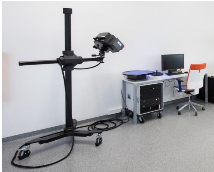
Rys. 34. Skaner optyczny Atos III Triple Scan 16M wraz ze stołem pomiarowym znajdującym się w Centrum Badawczo - Rozwojowym firmy Splast
