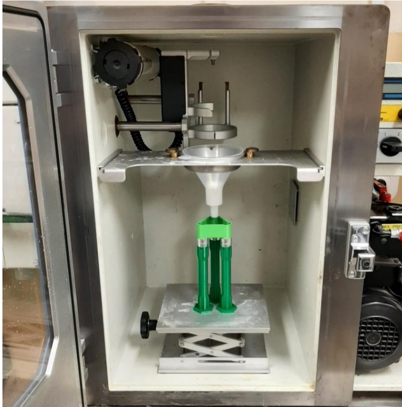
Rys. 4.11. Próbkę połączone z układem zalewowym umieszczone w komorze do odlewania próżniowego
