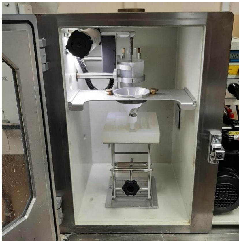
Rys. 4.9. Komora do odlewania próżniowego
