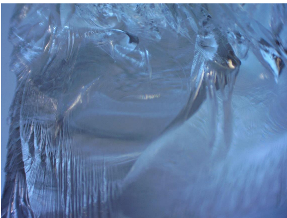
Rys. 5.93. Widok przełomu próbki z żywicy poliuretanowej PR700 przy czterdziestokrotnym powiększeniu
