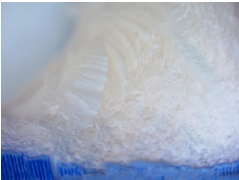
Rys. 5.66. Widok przełomu próbki z kopolimeru ABS i żywicy poliuretanowej PR2000 przy dziesięciokrotnym powiększeniu
