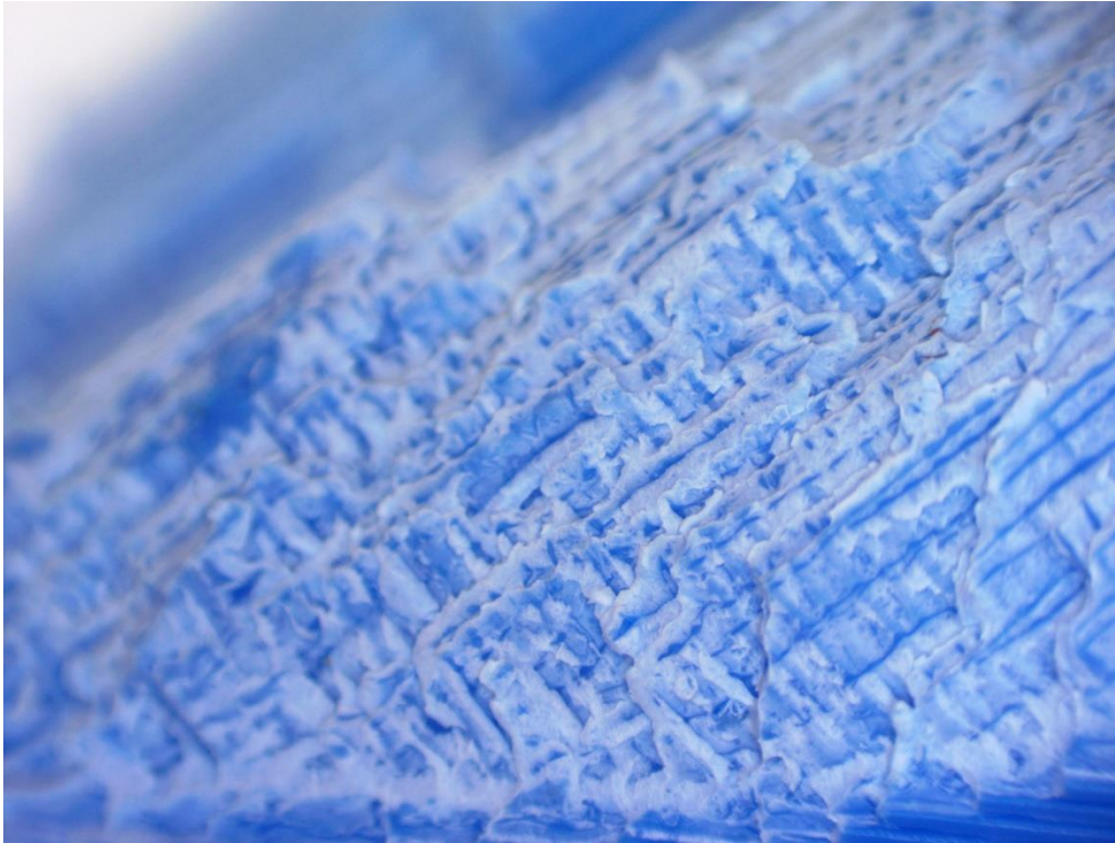
Rys. 5.61. Widok przełomu próbki z kopolimeru ABS otrzymanej w orientacji poziomej względem platformy roboczej urządzenia przy dziesięciokrotnym powiększeniu
