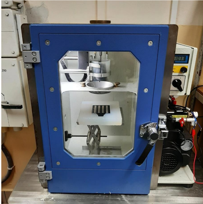
Rys. 4.18. Komora do odlewania próżniowego Schüchl UHG-400 Easy
