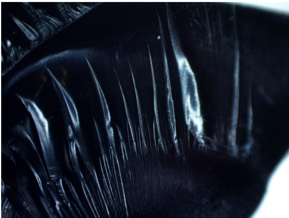
Rys. 5.92. Widok przelomu próbki z żywicy poliuretanowej PR700 przy dziesięciokrotnym powiększeniu
