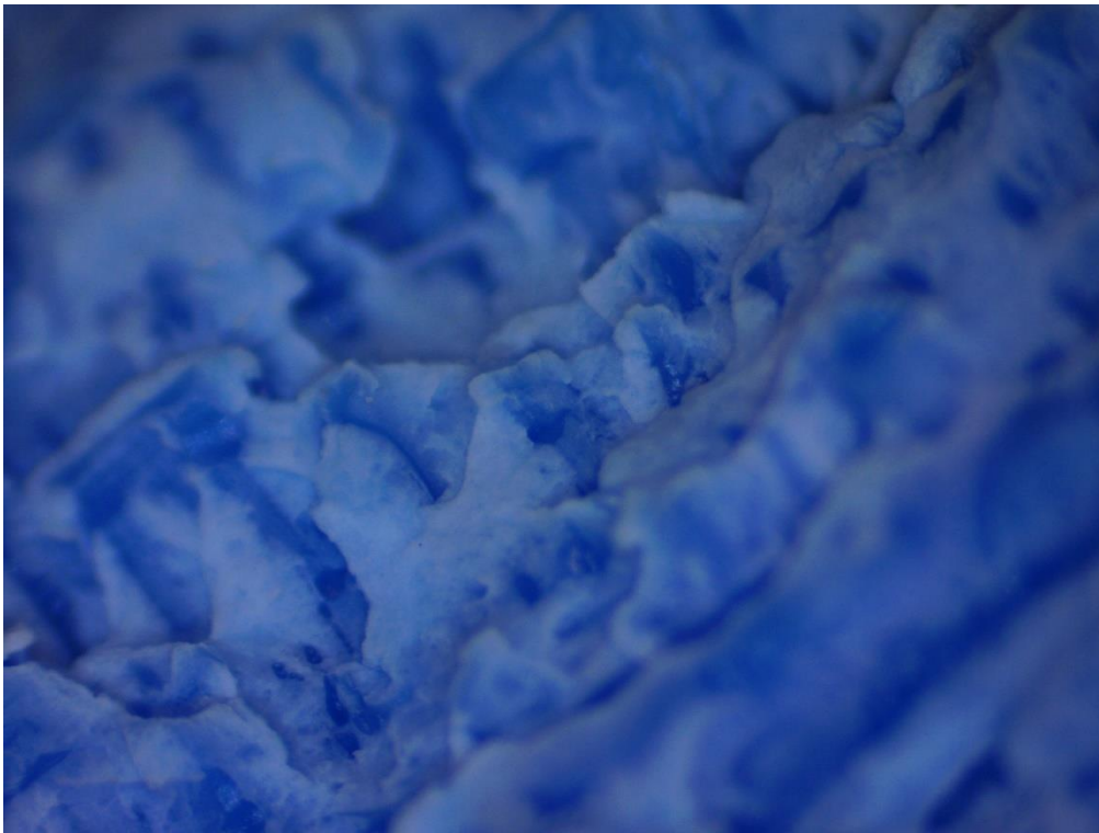
Rys. 5.62. Widok przełomu próbki z kopolimeru ABS otrzymanej w orientacji poziomej względem platformy roboczej urządzenia przy czterdziestokrotnym powiększeniu
