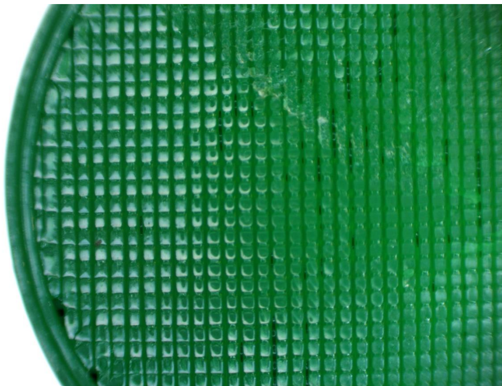
Rys. 5.74. Widok przełomu próbki z polilaktydu otrzymanej w orientacji pionowej względem platformy roboczej urządzenia przy dziesięciokrotnym powiększeniu
