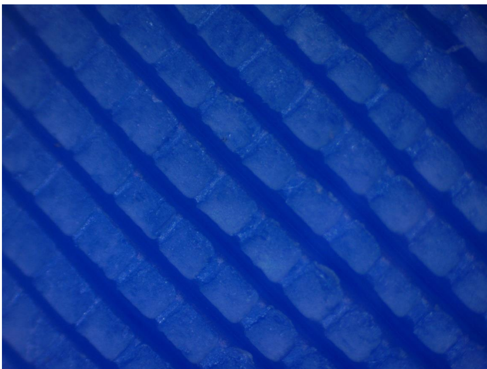
Rys. 5.60. Widok przełomu próbki z kopolimeru ABS otrzymanej w orientacji pionowej względem platformy roboczej urządzenia przy czterdziestokrotnym powiększeniu
