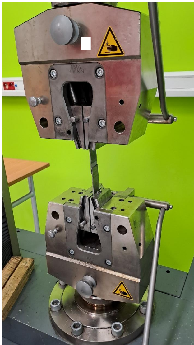
Rys. 4. 9. Położenie próbki połączenia klejowego w szczękach maszyny wytrzymałościowej [opracowanie własne]
