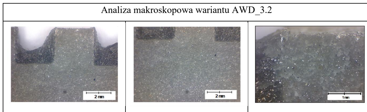
Rys. 4. 26. Powierzchnie pęknięć jednowarstwowych złączy klejonych dla wariantu z wcięciami szerokimi o długości 3 mm [opracowanie własne]
