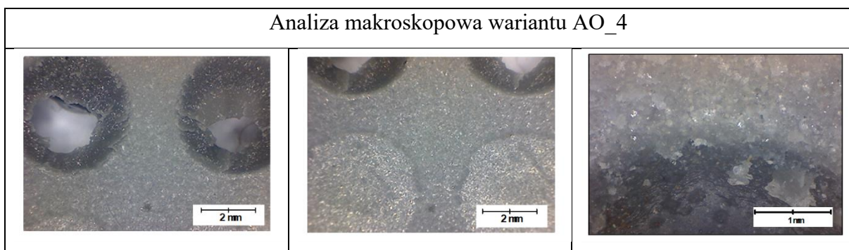
Rys. 4. 31. Powierzchnie pęknięć jednowarstwowych złączy klejonych dla wariantu z otworami o średnicy 4 mm [opracowanie własne]
