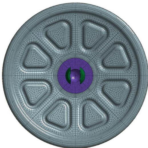
Rys. 6.5. Wizualizacja siatki elementów skończonych płyty: a) widok z wierzchu, b) widok od spodu
