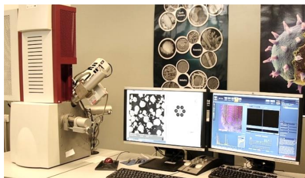
Rys. 3.9. Skaningowy mikroskop elektronowy MIRA3 firmy Tescan, wyposażony w detektor EDS do mikroanalizy składu chemicznego X-Max N firmy Oxford Instruments
