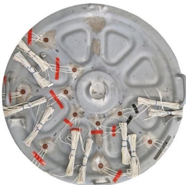
Rys. 5.8. Instalacja tensometryczna do pomiaru odkształceń podczas ostrzału
