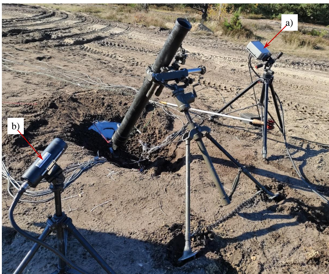
Rys. 4.7. Lokalizacja urządzeń mobilnego systemu radiolokacyjnego względem moździerza: a) radar, b) trigger
