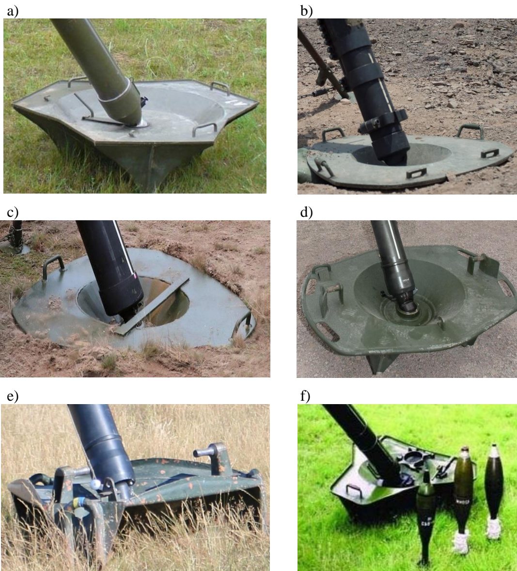
Rys. 1.4. Płyty oporowe moździerzy kalibru 120 mm: a) M1982 PRAM-L [24], b) Soltam K6 [25], c) Mörser 120 [26], d) 120 KRH-92 [27], e) 120 KRH/40 [28], f) typ W86 [29]
