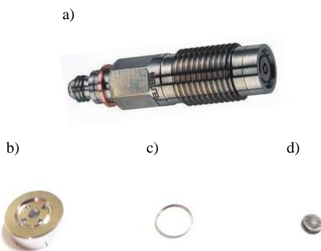
Rys. 4.4. a) czujnik piezoelektryczny Kistler typu 6215, b) nakładka ochronna, c) pierścień dystansowy, d) osłona termiczna
