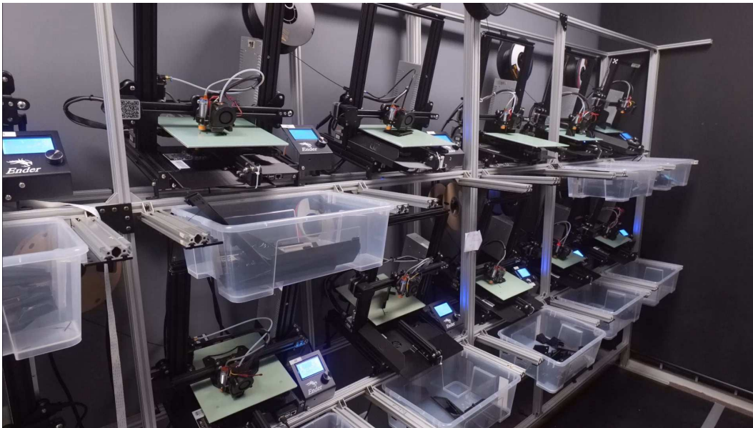
Rys. 2.8. Zautomatyzowana farma drukarek 3D wykorzystujących rozwiązania firmy 3DQue [83]
