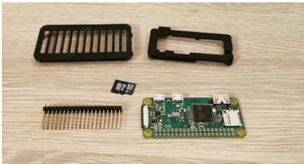
Rys. 4.4. Elementy użyte do modyfikacji sprzętowej w celu rozszerzenia Prusa i3 MK3 o funkcjonalność sieciową
