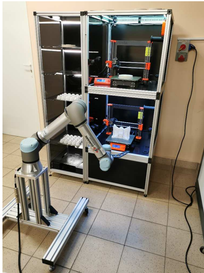
Rys. 4.25. Zautomatyzowana stacja druku 3D – stanowisko badawcze
