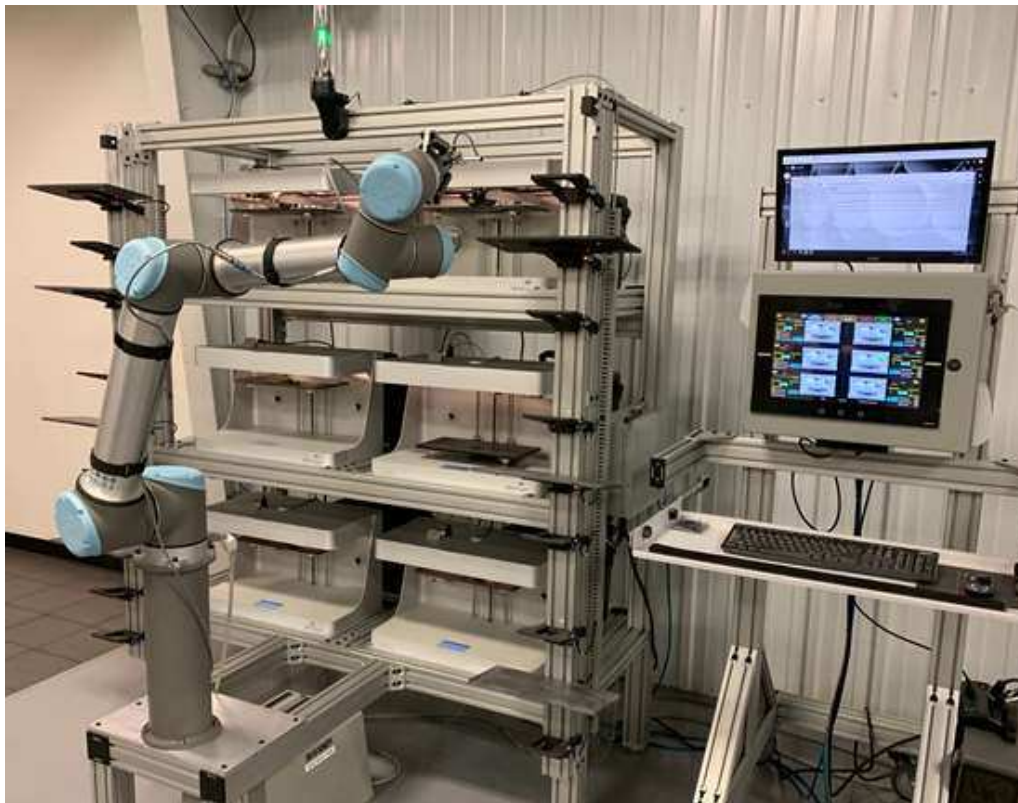
Rys. 2.10. Autonomiczny system wymiany platform roboczych w drukarkach 3D w firmie Evco Plastic [87]
