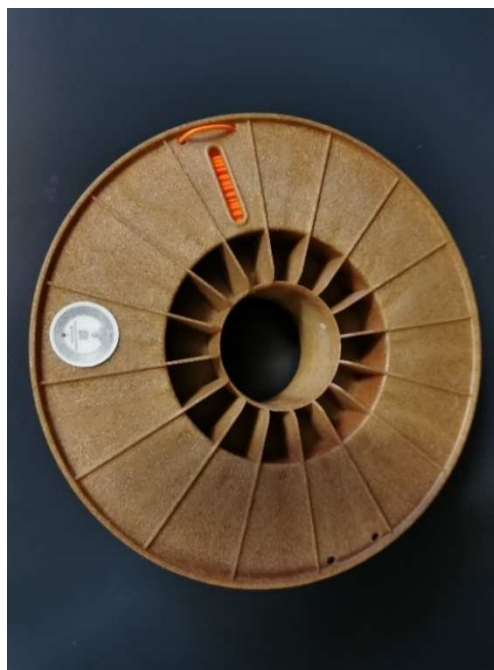
Rys. 4.11. Szpula oznaczona tagiem RFID
