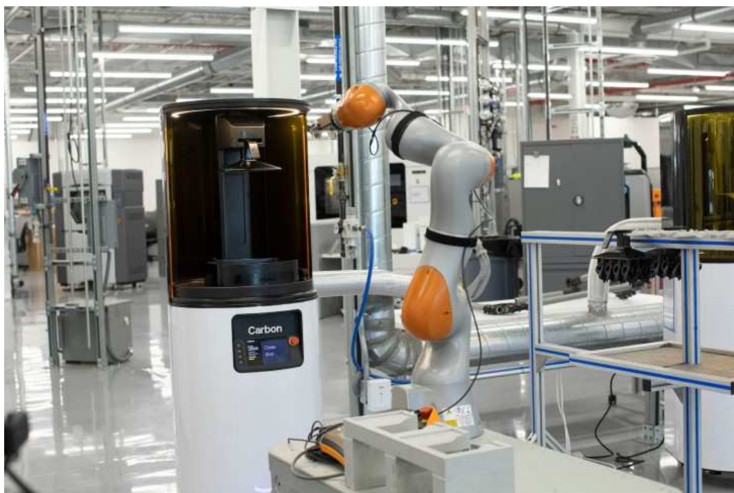
Rys. 2.9. Współpraca autonomicznego robota mobilnego z drukarką 3D w firmie Ford [86]
