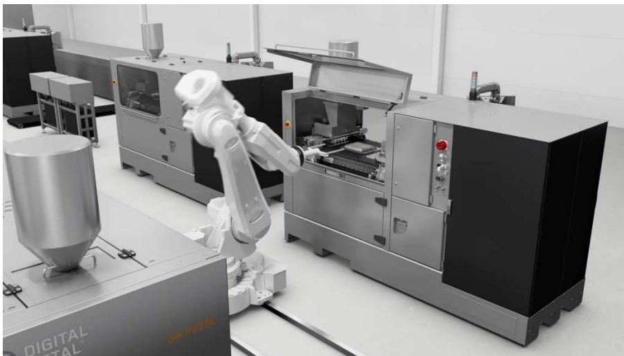
Rys. 2.3. Koncepcyjna automatyczna linia produkcyjna zaprezentowana przed Digital Metal [35]
