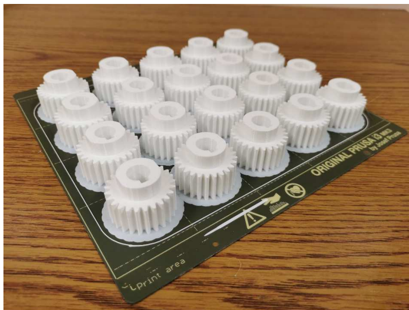
Rys. 5.6. Model badawczy – koło zębate KZ-2 (konfiguracja 20 szt. na platformie roboczej)
