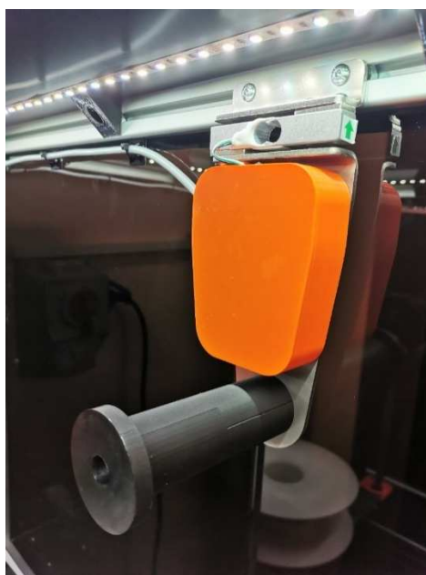
Rys. 4.7. Opracowany uchwyt szpuli wyposażony w wagę w postaci belki tensometrycznej
