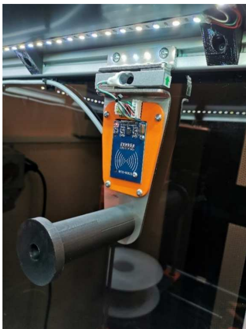
Rys. 4.10. Czytnik tagów RFID zabudowany w uchwycie szpuli
