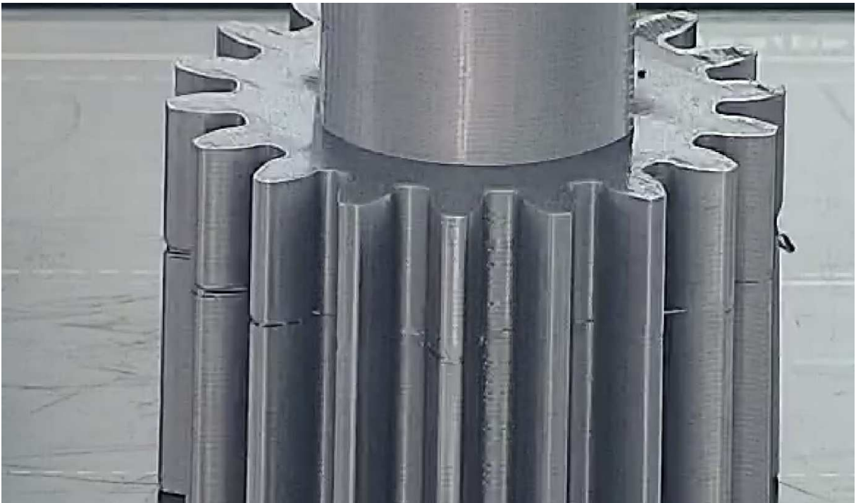
Rys. 4.15. Obraz modelu koła zębatego rejestrowany ze znacznej odległości przez kamerę o dużym przybliżeniu – widoczny efekt rozwarstwienia
