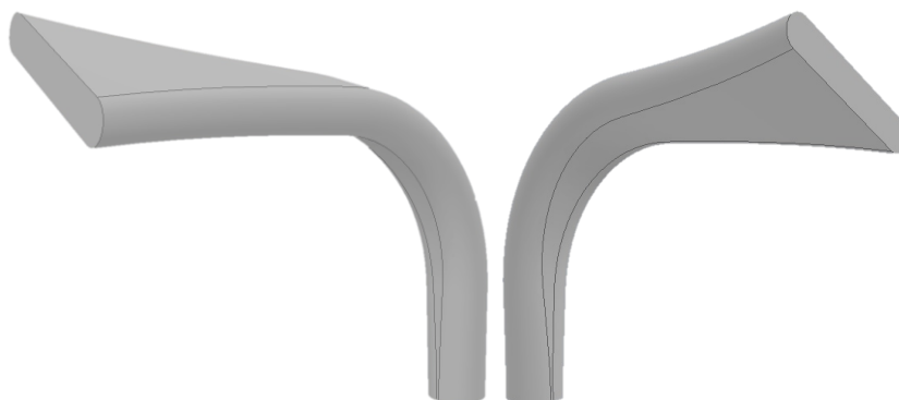
Rys.3.8. Widok dyfuzora zakrzywionego w dwóch rzutach
