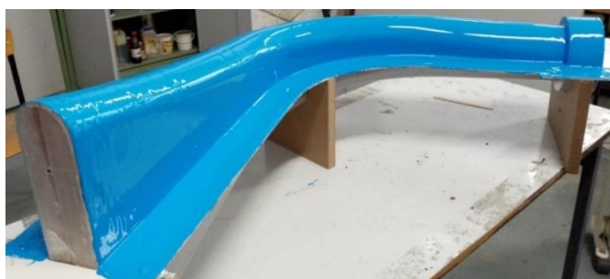
Rys.5.11. Kopyto dyfuzora z warstwą żywicy
