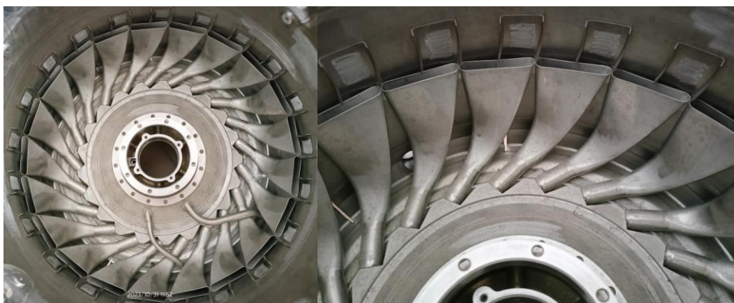
Rys.1.7. Widok zespołu dyfuzorów zakrzywionych [przekazany przez firmę Pratt&Whitney jako dar Politechnice Rzeszowskiej]
