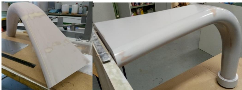
Rys.5.9. Kopyto dyfuzora wykonanego z płyty modelarskiej
