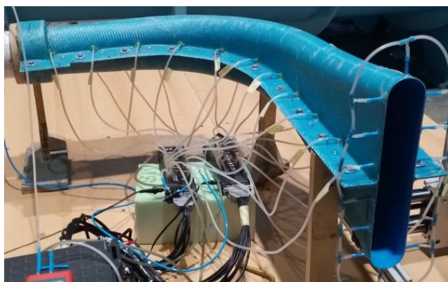
Rys.5.26. Widok punktów pomiarowych do pomiaru ciśnienia statycznego na ścianie wewnętrznej kanału
