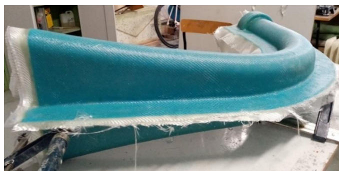
Rys.5.12. Kopyto dyfuzora z wyścielonym włóknem szklanym
