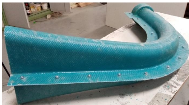
Rys.5.13. Model dyfuzora zakrzywionego złożonego z dwóch połówek
