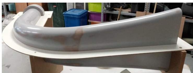
Rys.5.10. Kopyto dyfuzora wraz z jego podziałem na połówkę górną i dolną
