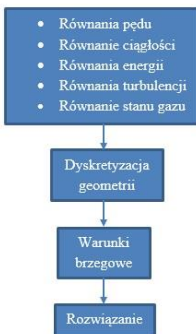
Rys.7.1. Schemat działania symulacji AnsysFluent
