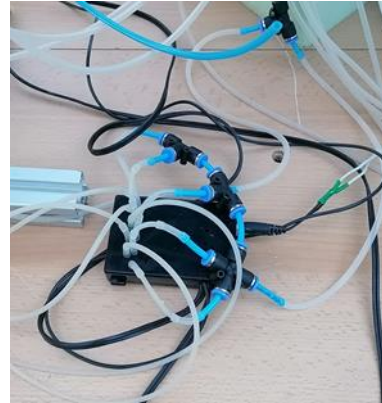
Rys.5.37. Skaner 5-kanałowy do sondy kierunkowej
