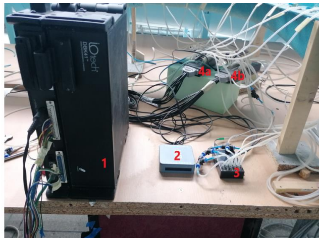
Rys.5.38. Widok na systemy pomiarowe: 1-DAQBOOK 2001, 2-USB-231, 3-skaner sondy kierunkowej, 4a, 4b-skanery ciśnień 2x16 kanałów
