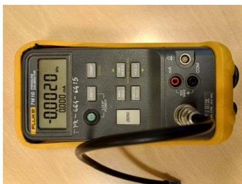
Rys.5.23. Kalibrator ciśnienia FLUKE 718-1G
