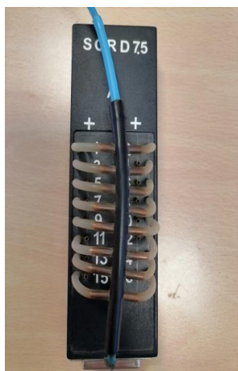
Rys.5.21. Moduł 16 - kanałowego skanera ciśnień
