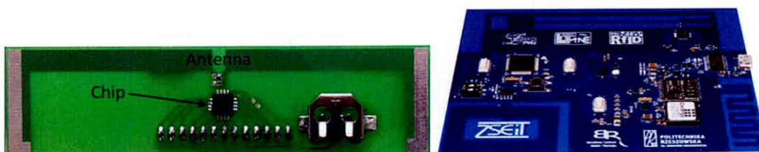
Rys. 21. Testowane identyfikatory RFID pasma UHF: a) projekt z anteną dookólną, b) projekt z anteną kierunkową
