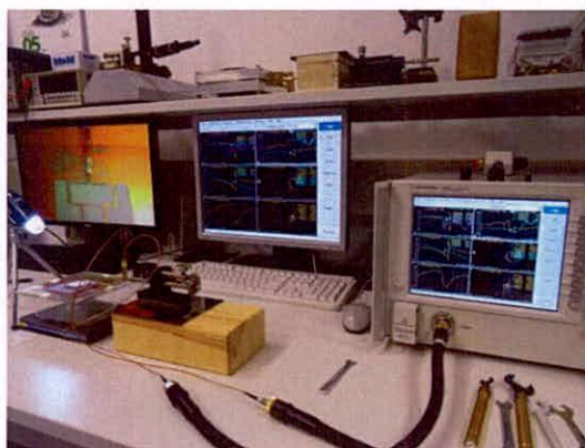
Rys. 9. Stanowisko do wyznaczania parametrów impedancyjnych.
